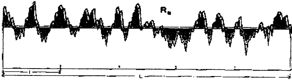
Şekil 2.9.1 R_a Parametresinin Şematik Gösterimi
