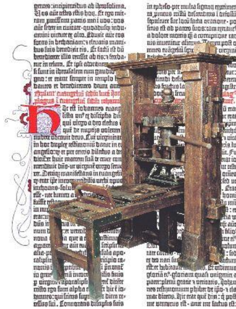
Resim 1.17. Gutenberg'in 1455 yılında kullandığı yüksek baskı makinesi ve '42 Satırlı Kitab-ı Mukaddes' ( http://www.koluthse.jp/ )
