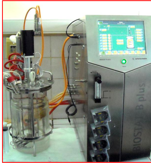
Şekil 3.1. Sartorius Biostat B Plus Biyoreaktör
