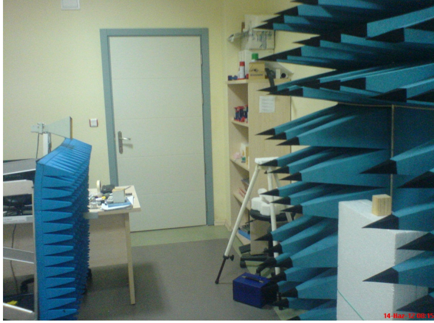
Şekil 3.6 Yakın Alan Ölçüm Laboratuvarı. Tarayıcı Sistem ( solda ). Işıma Soğurucu RAM'ler, Taranan Nesne ve Altında Bulunan Köpük Destek ( sağda ).
