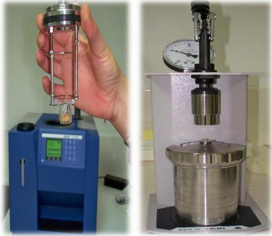
ekil 3.11. Atı ın ısıl de erini ölçmek için kullanılan bomba kalorimetre
