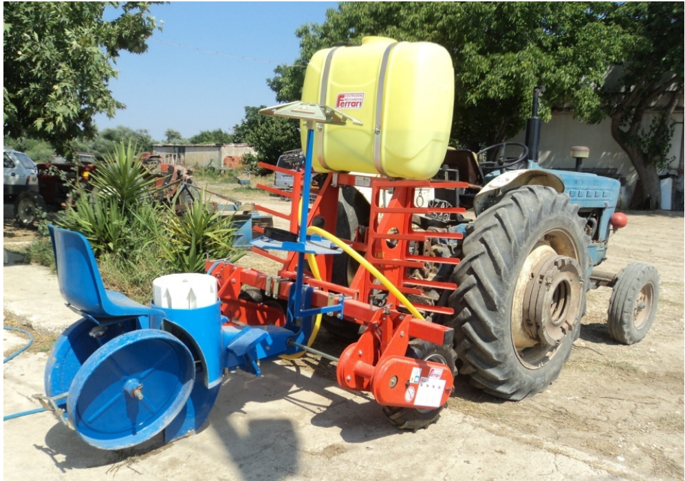
řekil 3.1. Yatay magazinli fide dikim makinesi
