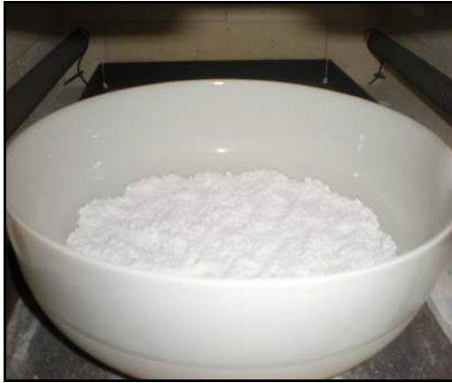
Şekil 2.3. MCM-41'in kalsinasyon öncesi fırın içerisindeki görüntüsü
