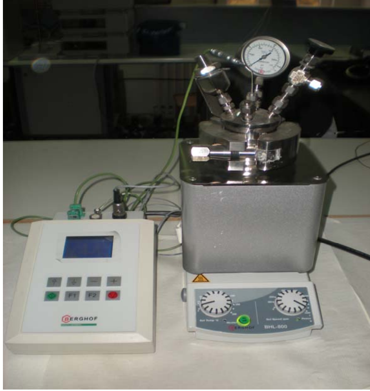
Şekil 2.2. MCM-41'in hazırlanması için kullanılan BERGHOF BR-200 reaktör.
