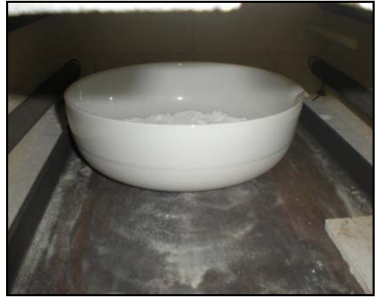
Şekil 2.3. MCM-41'in kalsinasyon öncesi fırın içerisindeki görüntüsü
