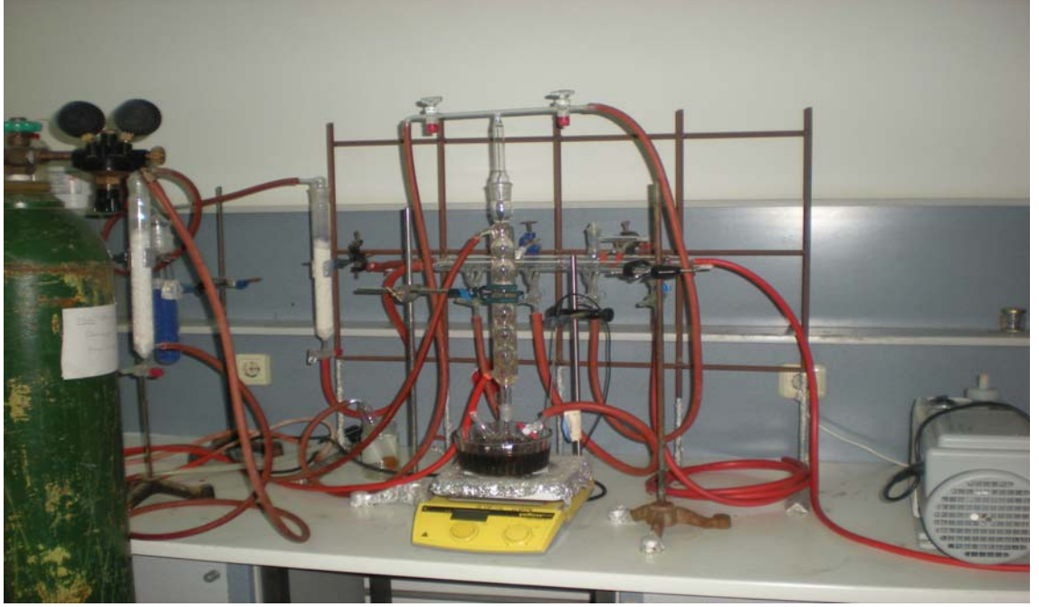
Şekil 2.4. Heterojen katalizör varlığında MPV indirgenme reaksiyonu düzeneği
