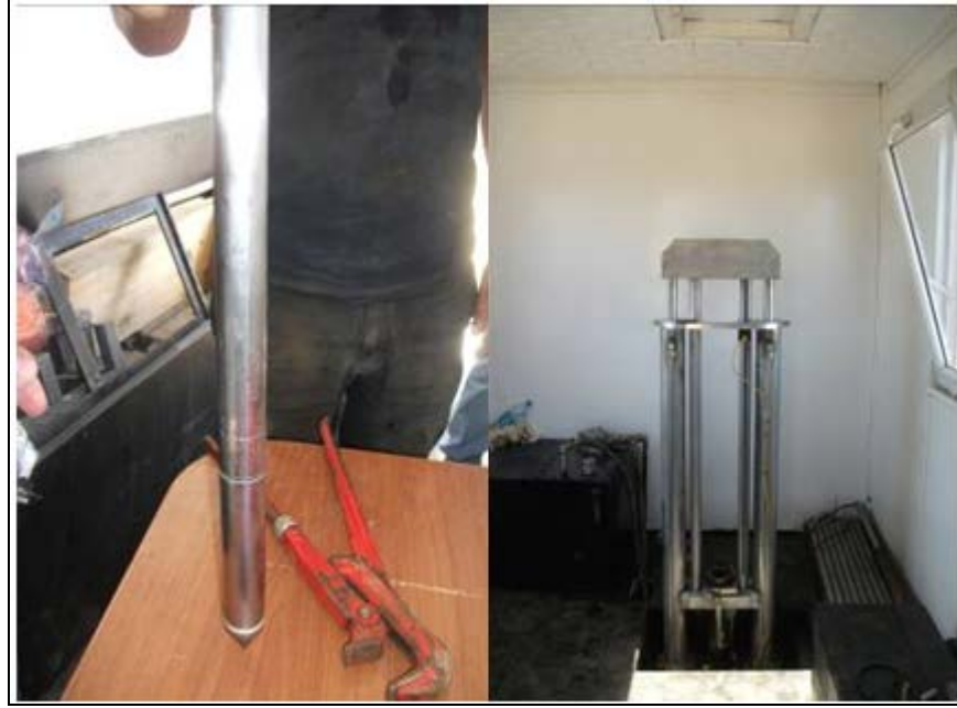
Şekil 3.5. Çalışmada kullanılan konik penetrasyon deneyi ekipmanları
