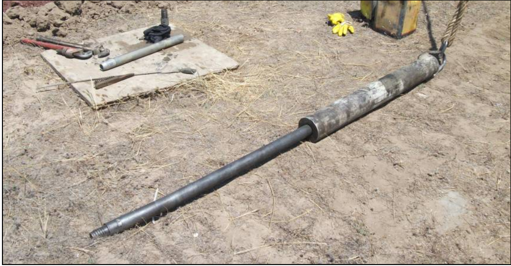
Şekil 3.2. SPT deneyinde kullanılan güvenli şahmerdan (safety hammer)
