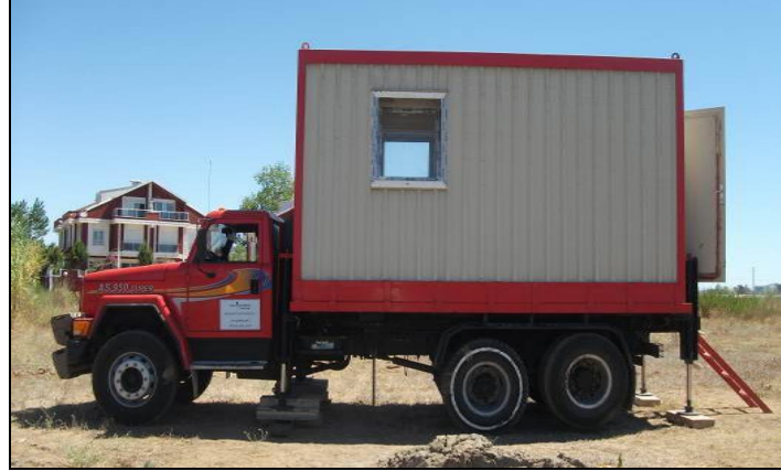
Şekil 3.6. Konik penetrasyon deney düzeneğinin yerleştirildiği kamyon
