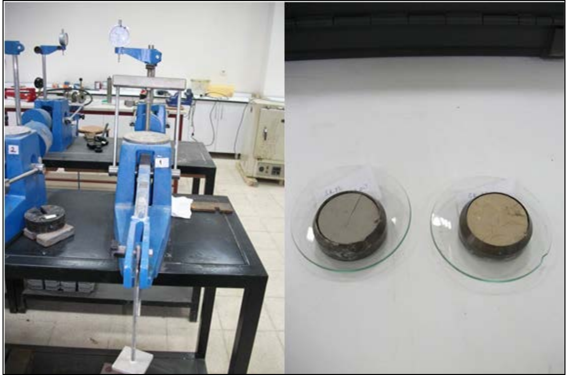
Şekil 3.15. Konsolidasyon deney düzeneği ve deney sonrası halka içindeki numuneler
