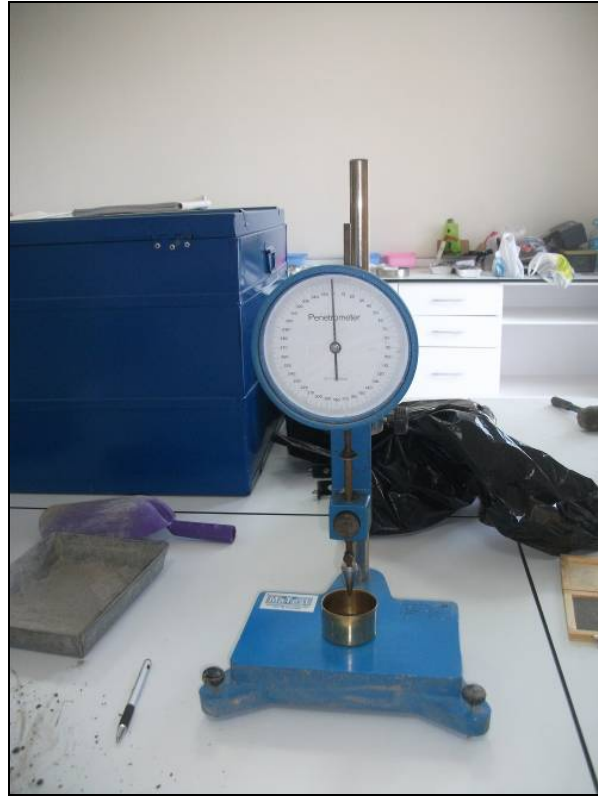
Şekil 3.13. Likit limit deneyinde kullanılan penetrometre cihazı
