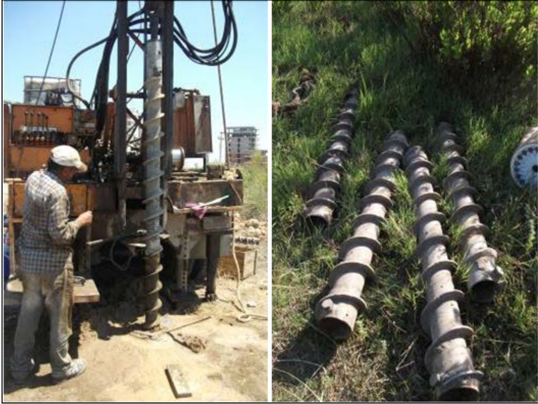
Şekil 3.1 Çalışma kapsamında kullanılan sondaj makinesi ve augerler
