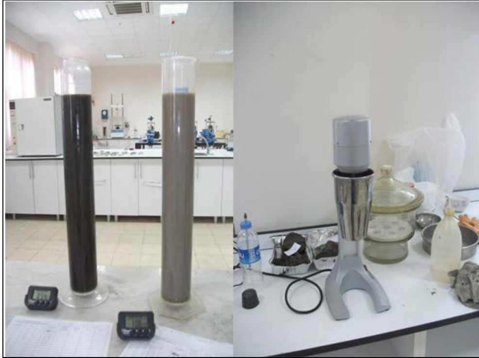
Őekil 3.12. Hidrometre deneyinde kullanılan mezr, kronometre ve mekanik karıřtırıcı
