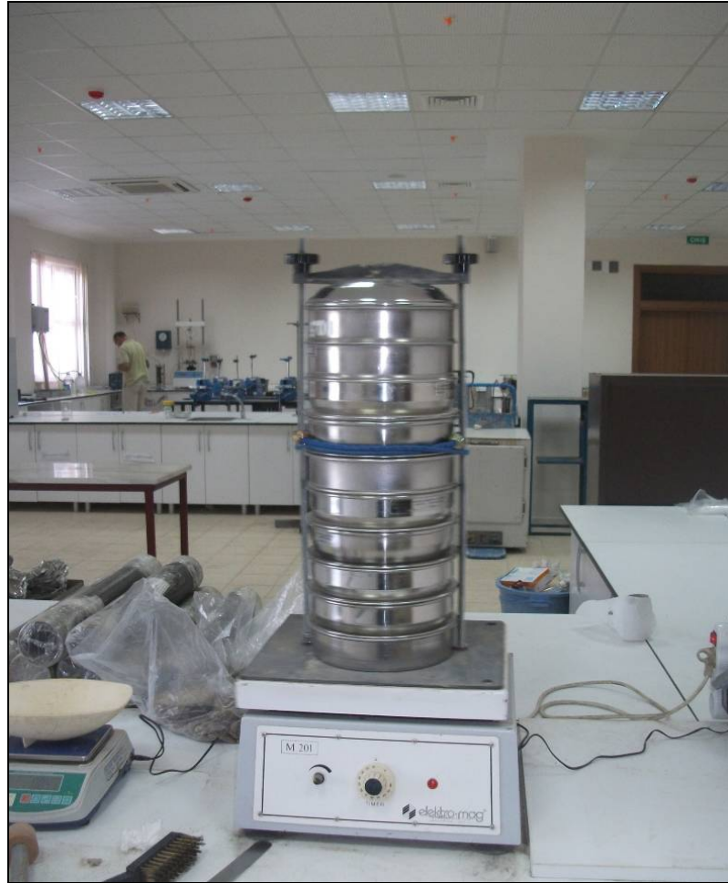
Şekil 3.11. Elek analizi deneyinde kullanılan farklı çaptaki elekler ve sarsma makinesi
