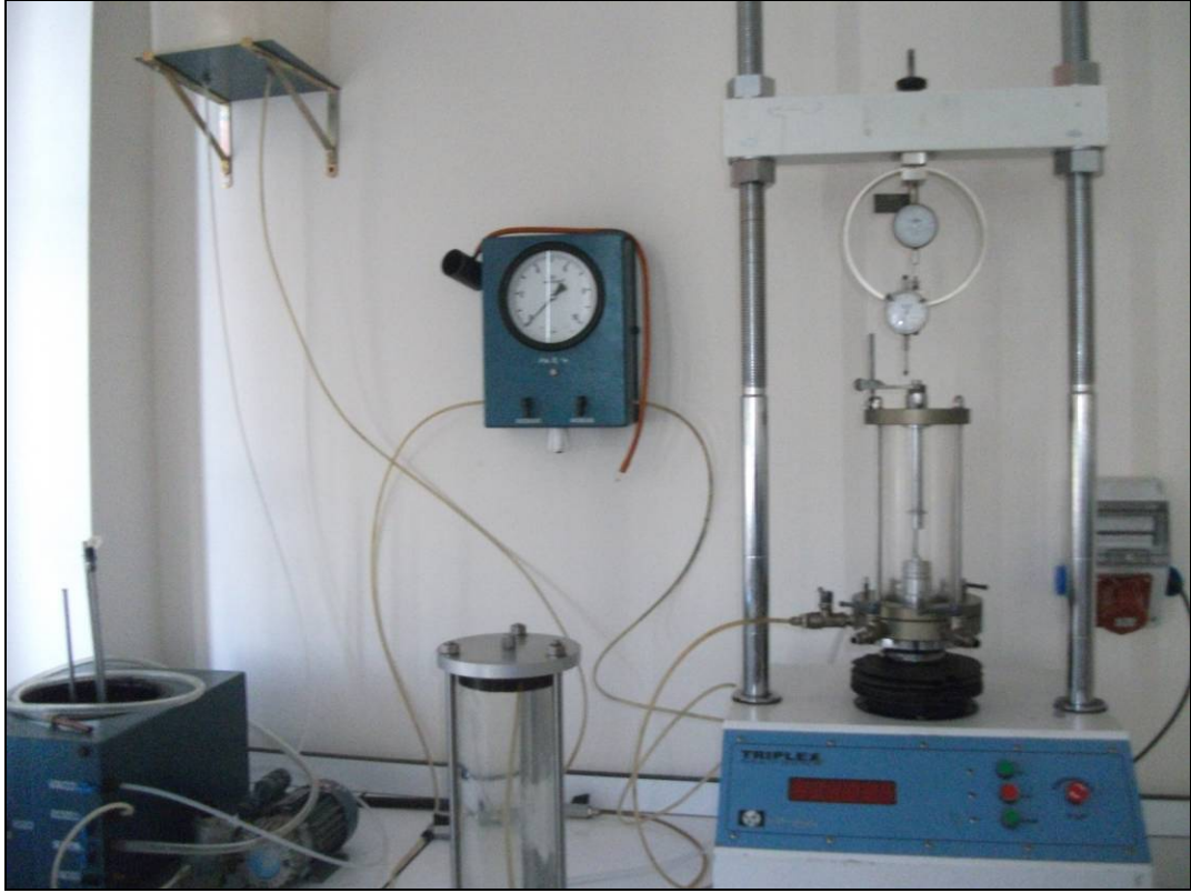
Şekil 3.14. Üç eksenli basınç deneyi düzeneği
