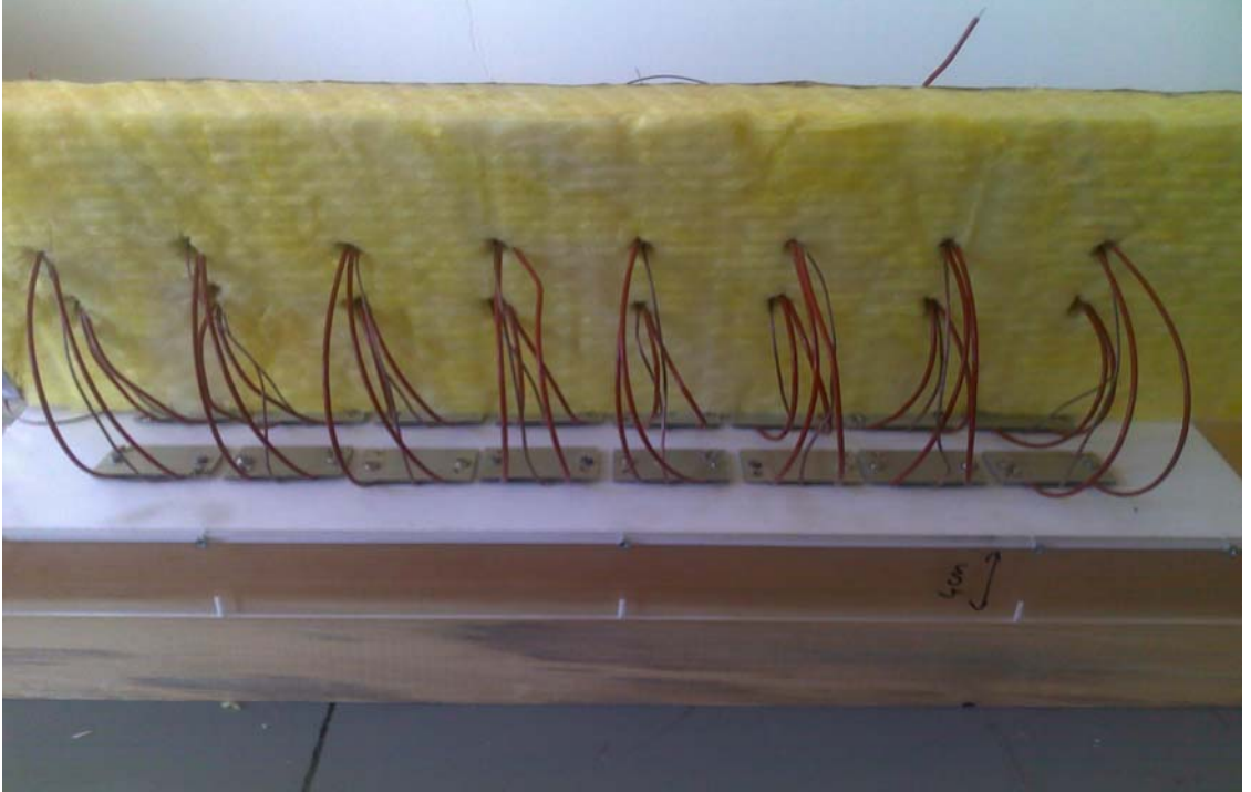
Şekil 3.6. Isıtıcıların cam yünü ile kaplanması
