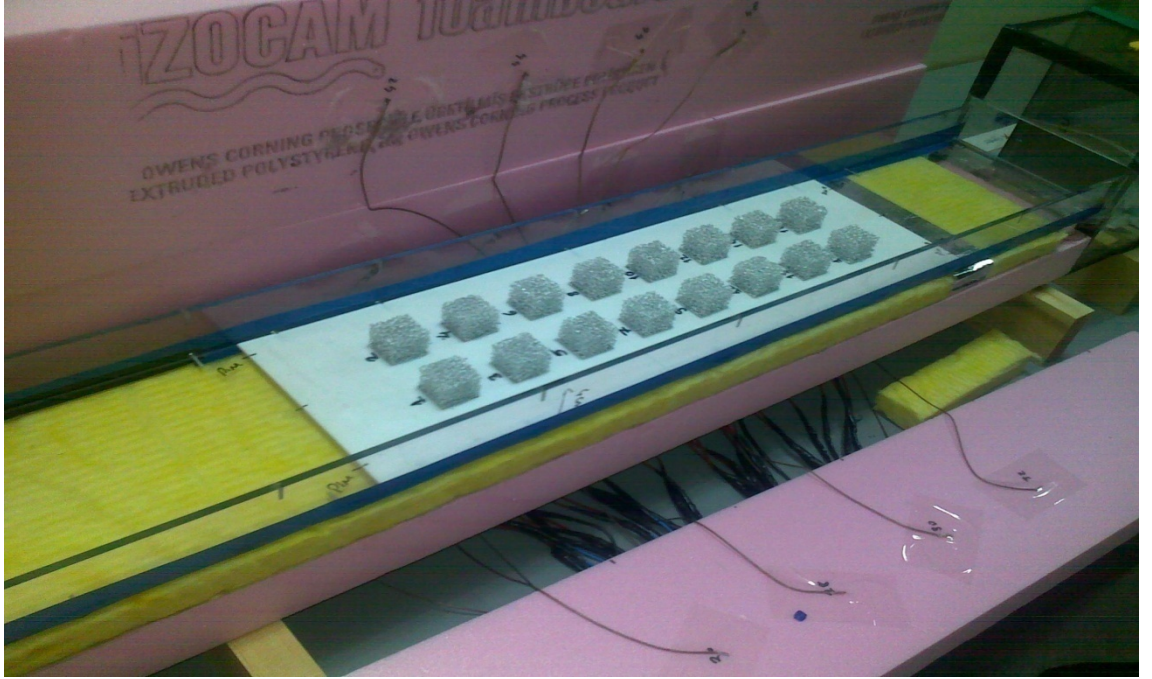
Şekil 3.10. Alüminyum köpük blokların test bölgesine yerleşimi
