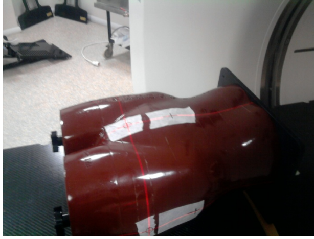
Şekil 3.10. Rando fantomun BT cihazında (a) supin pozisyonu (b) tarama bölgesi
