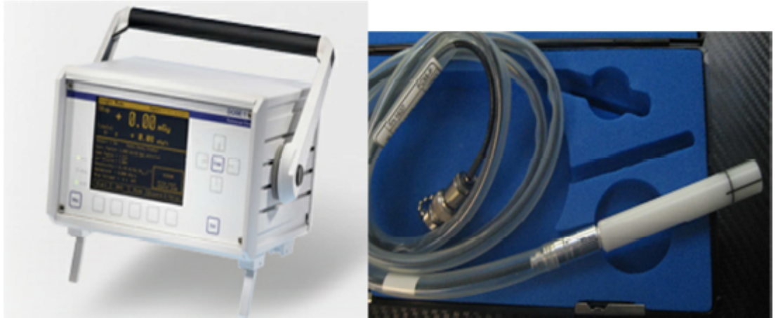
Şekil 3.2. DOSE 1 model elektrometre ve FC65P iyon odası
