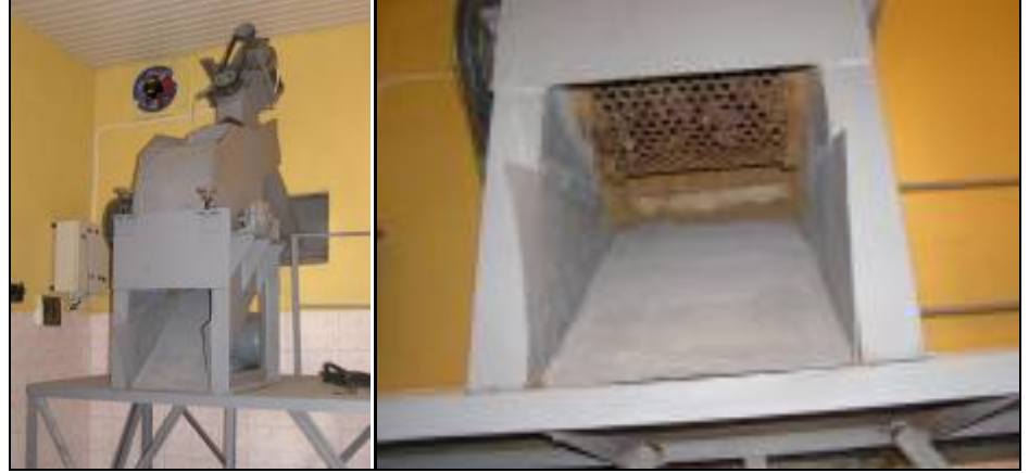
Şekil 3.1. Andız meyvelerini kırmak için kullanılan makine ve iç kısmı (Kocakulak 2007)
