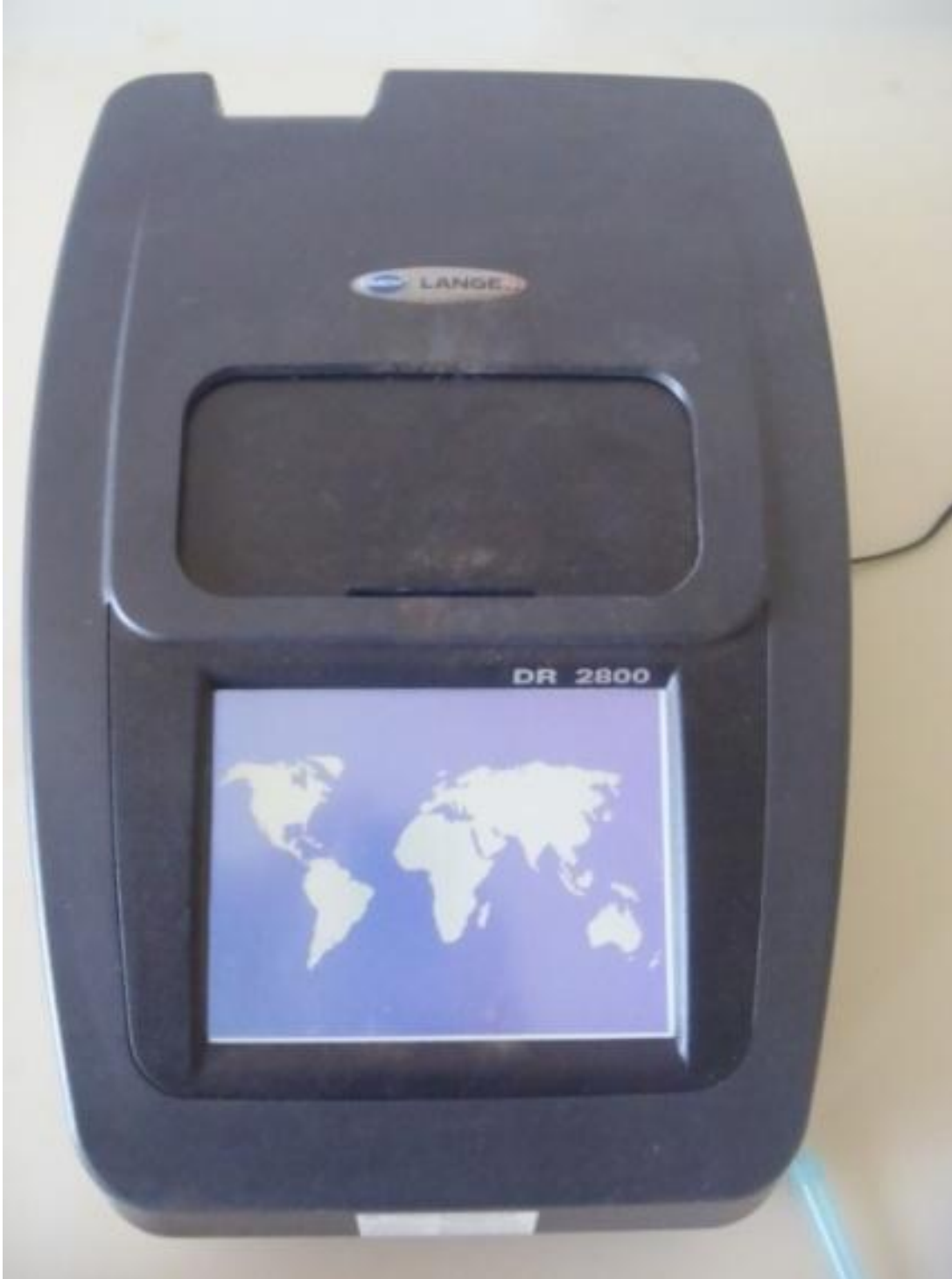
Şekil 3.5. DR 2800 (Hach-Lange, USA) taşınabilir spektrofotometre.
