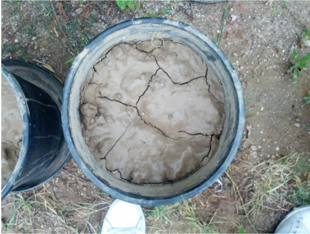
Şekil 4.1. Denemede kullanılan saksılardaki toprak yüzeyinde oluşan çatlaklar.
