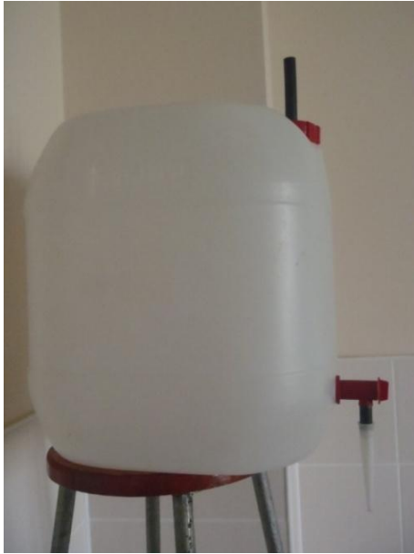
Şekil 3.14. Sabit debide su uygulamak için Mariotte tüpü ilkesine göre hazırlanan bidonlar.
