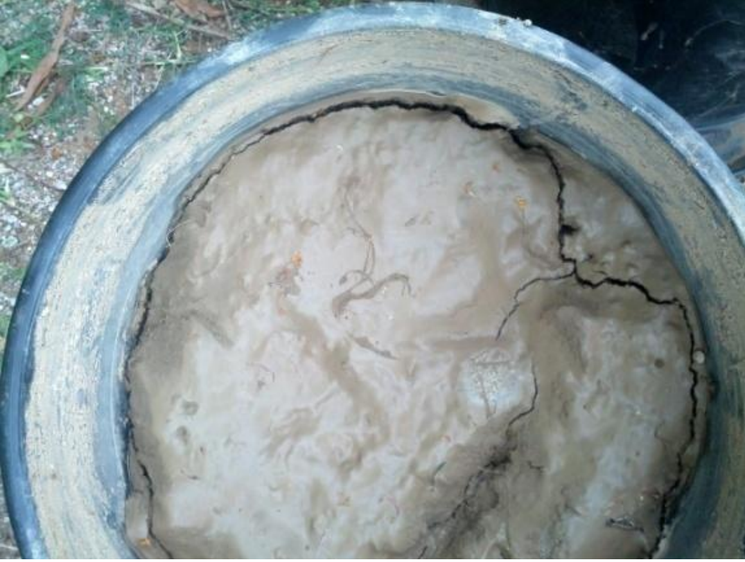
Şekil 4.3. Denemde tınlı toprakta saksı ve toprağın bileşim yüzeyleri arasında çatlak oluşan bir saksımın görüntüsü.
