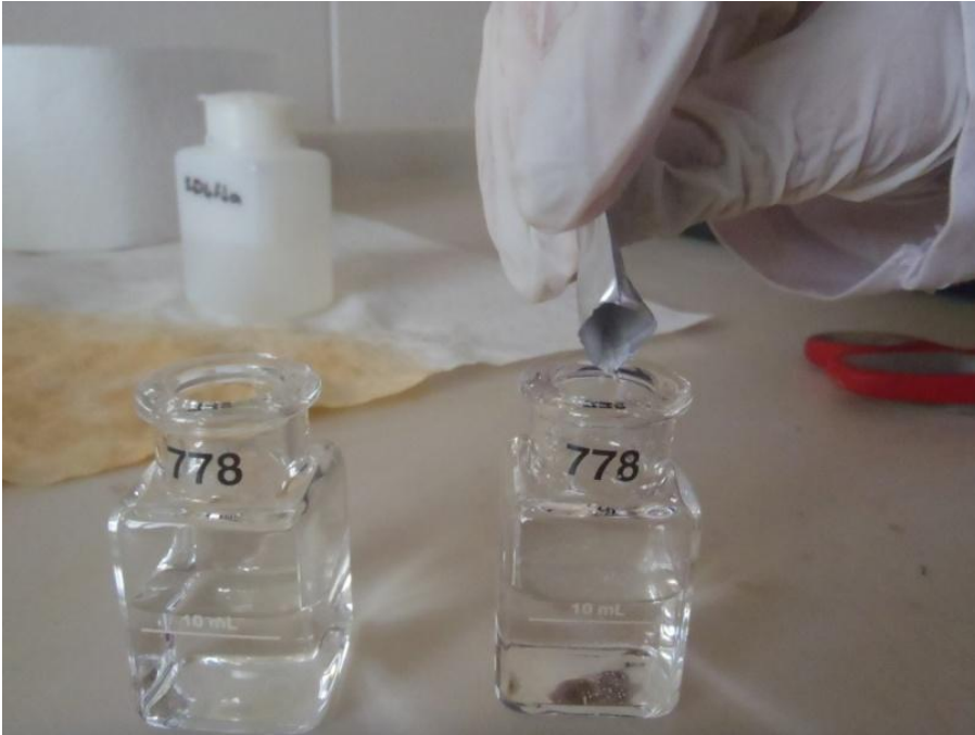
Şekil 3.18. Süzüklerle Nitraver 5 Nitrat Reaktif Powder Pillow ilave edilme işlemi.
