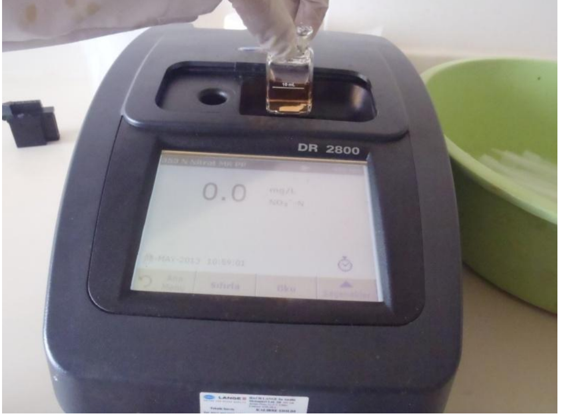
Şekil 3.19. Süzükte \text{NO}_3\text{-N} miktarının spektrofotometre ile okuma işlemi.
