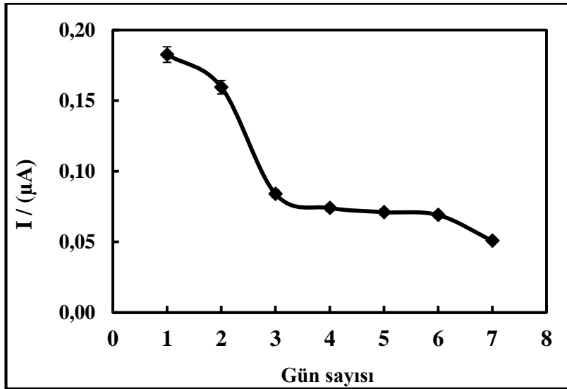
Şekil 4.66. YBCE/MWCNT/AuNP/PNR/ADH/GA biyosensörünün 400 \mu M etanol derişimine karşı elde edilen akım değerleri-gün sayısı grafiği (+ 0,2 V, 50 mM pH 7,5 fosfat tamponu, 0,1 M KCl)
