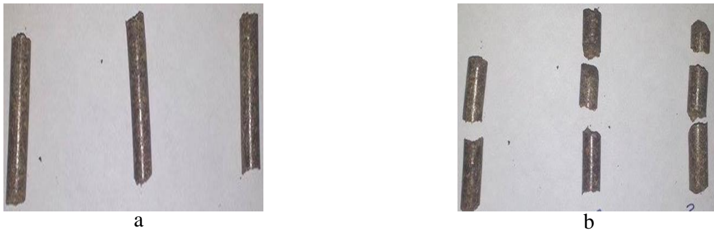
Şekil 4.13. S2 peleti kırılma direnci test öncesi (a) ve test sonrası (b) görünüşleri
