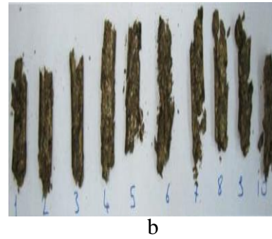
Şekil 4.18. S1 peleti sıkıştırma direnci test öncesi (a) ve sonrası (b) görünüşleri
