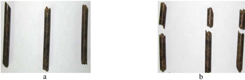
Şekil 4.9. P1 peleti kırılma direnci test öncesi (a) ve test sonrası (b) görünümleri
