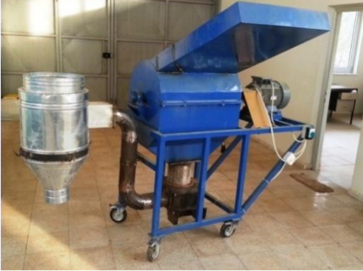
Şekil 3.3. Çekiçli değirmen genel görünüşü ve öğütme ünitesi
