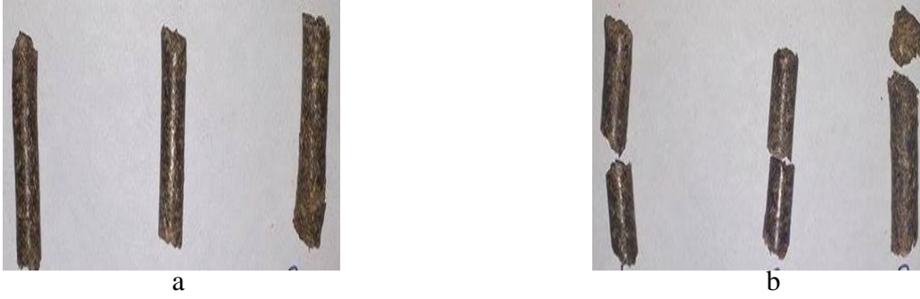
Şekil 4.14. S3 peleti kırılma direnci test öncesi (a) ve test sonrası (b) görünümüleri
