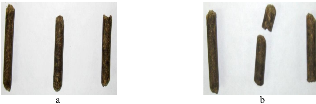
Şekil 4.10. P2 peleti kırılma direnci test öncesi (a) ve test sonrası (b) görünümleri
