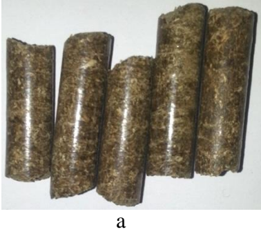
Şekil 4.34. S2 peleti nem alma direnci test öncesi (a) ve sonrası (b) görünümü
