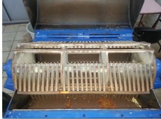
Şekil 3.3. Çekiçli değirmen genel görünüşü ve öğütme ünitesi
