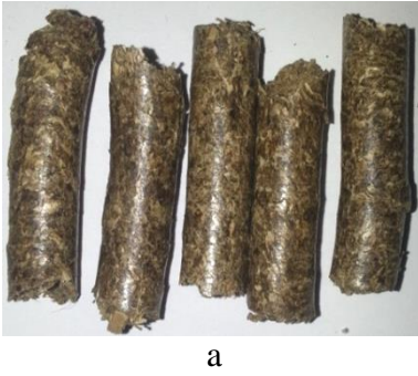
Şekil 4.35. S3 peleti nem alma direnci test öncesi (a) ve sonrası (b) görünümü
