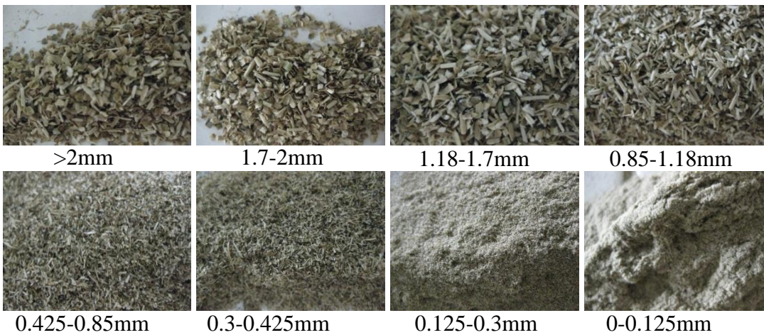
Şekil 3.19. Elek analizi sonrası öğütülmüş susam sapsularının boyut dağılımı
