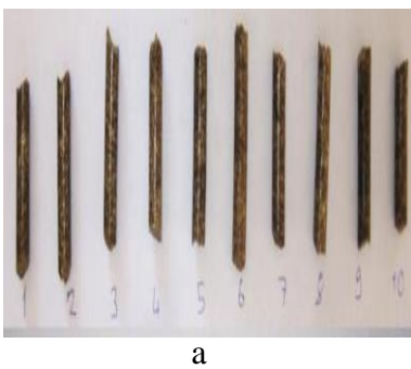
Şekil 4.19. S2 peleti sıkıştırma direnci test öncesi (a) ve sonrası (b) görünüşleri
