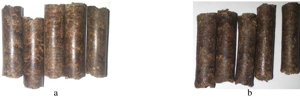
Şekil 4.30. P1 peleti nem alma direnci test öncesi (a) ve sonrası (b) görünümleri
