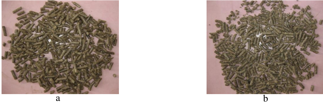
Şekil 4.6. S3 peleti dayanıklılık direnci test öncesi (a) ve sonrası (b) görünüşleri
