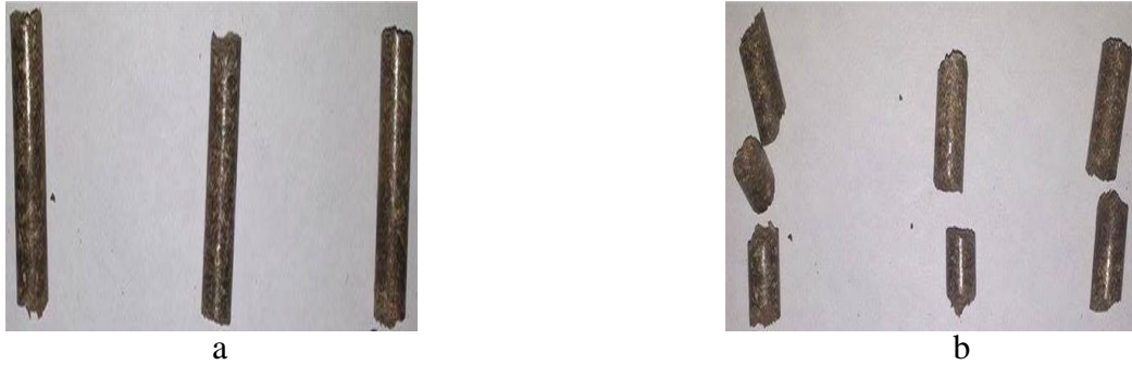
Şekil 4.12. S1 peleti kırılma direnci test öncesi (a) ve test sonrası (b) görünüşleri
