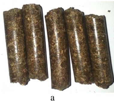
Şekil 4.33. S1 peleti nem alma direnci test öncesi (a) ve sonrası (b) görünümüleri
