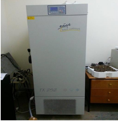
Şekil 3.10. İklimlendirme test kabini
