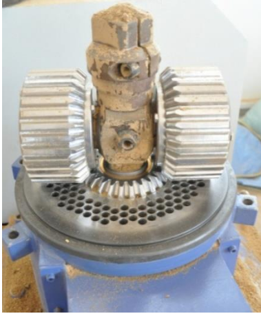
Şekil 3.5. Pelet makinası sıkıştırma diskleri ve kalıp
