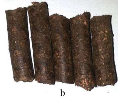
Şekil 4.31. P2 peleti nem alma direnci test öncesi (a) ve sonrası (b) görünümüleri
