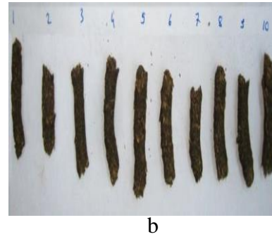
Şekil 4.17. P3 peleti sıkıştırma direnci test öncesi (a) ve sonrası (b) görünüşleri
