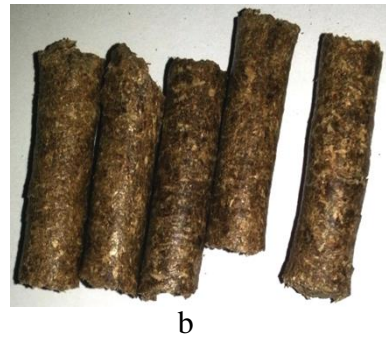
Şekil 4.33. S1 peleti nem alma direnci test öncesi (a) ve sonrası (b) görünümüleri
