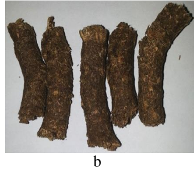
Şekil 4.32. P3 peleti nem alma direnci test öncesi (a) ve sonrası (b) görünümüleri
