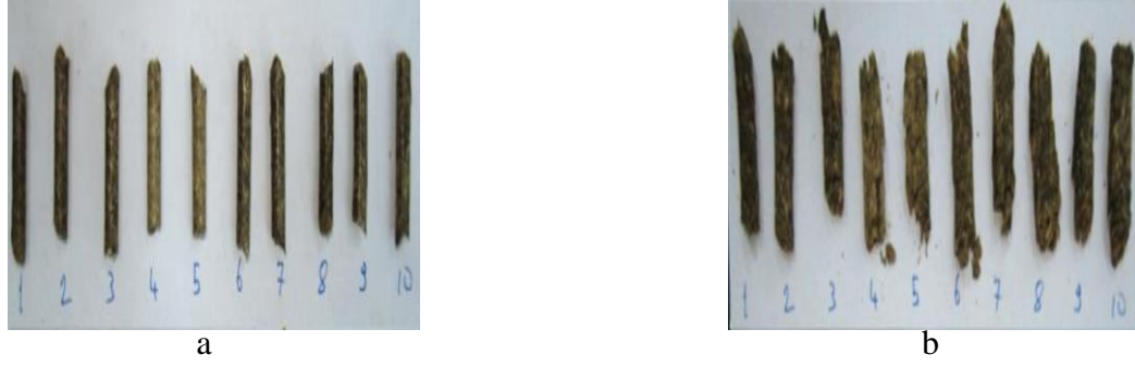
Şekil 4.20. S3 peleti sıkıştırma direnci test öncesi (a) ve sonrası (b) görünüşleri
