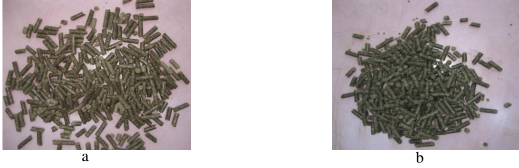
Şekil 4.5. S2 peleti dayanıklılık direnci test öncesi (a) ve sonrası (b) görünüşleri
