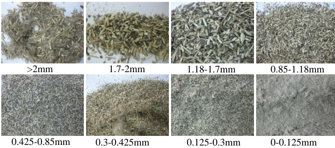
Şekil 3.18. Elek analizi sonrası öğütülmüş pamuk sapsularının boyut dağılımı
