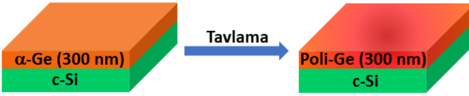
Şekil 4.29. Ge ince filmlerin katı faz kristallenme sonrası amorf fazdan kristal faza geçiş süreci
