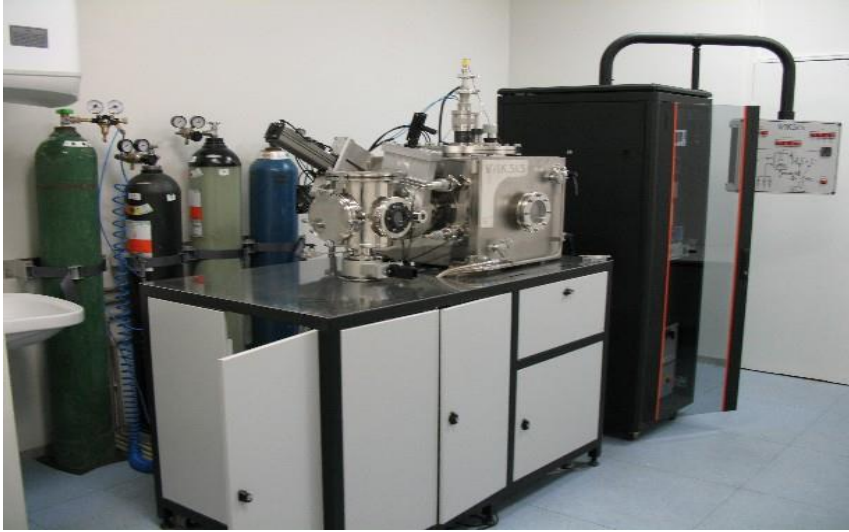
Şekil 3.9. Çalışmada kullanılan Nano D100 magnetron saçırma sistemi
