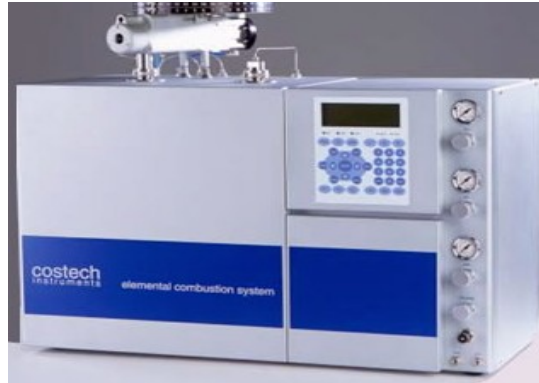
Şekil 3.3. Costech ECS 4010 marka elementel analiz cihazı
