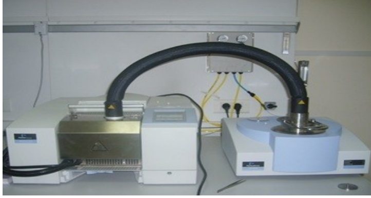
Şekil 3.4. TGA/FTIR çalışmasında kullanılan cihaz
