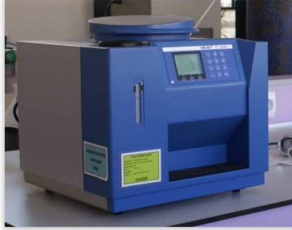
Şekil 3.2. IKA C200 marka kalorimetre cihazı
