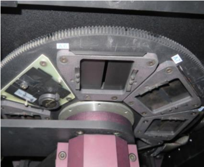
Şekil 3.26. Yarık ve pinhole'un takıldığı odak düzlemi
