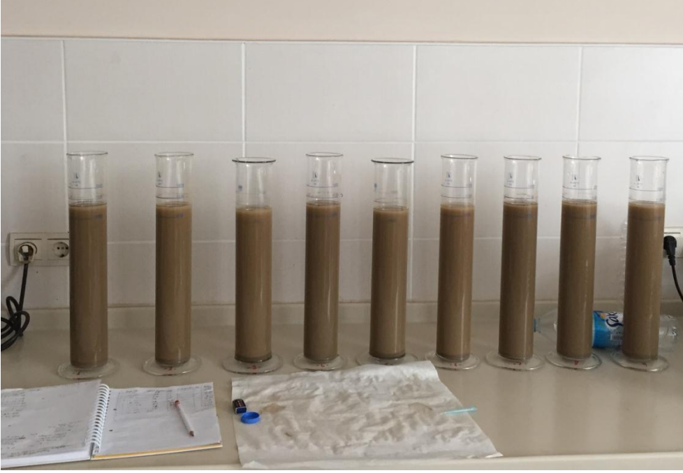
Şekil 3.4. Tekstür bileşenlerinin Bouyoucus hidrometre yöntemi ile belirlenmesi
