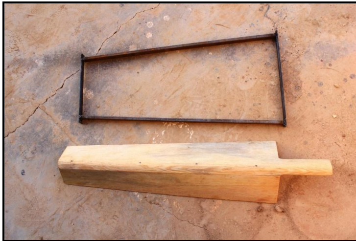
Resim 104. Kapama Kiremit Yapımında Kullanılan Kalıplar.
