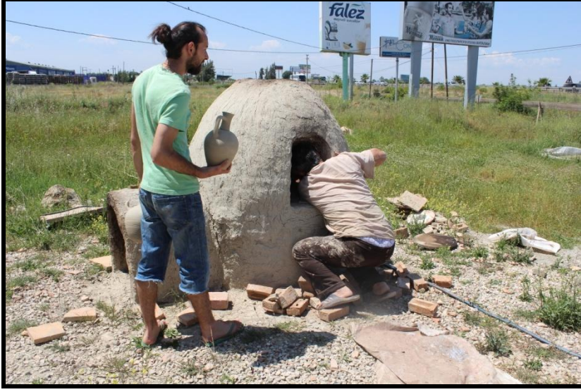
Resim 114. Seramik Ürünlerin Fırına Yerleştirilmesi.
