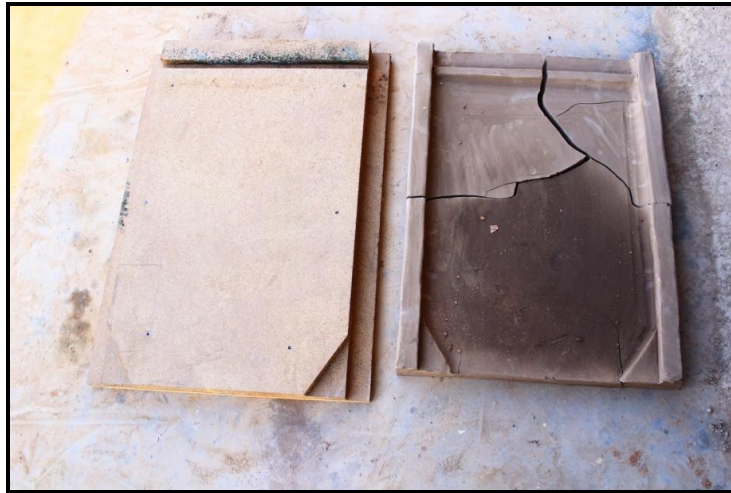
Resim 109. Bütün Kalıp Yardımıyla Korint Kiremit Yapımı.
