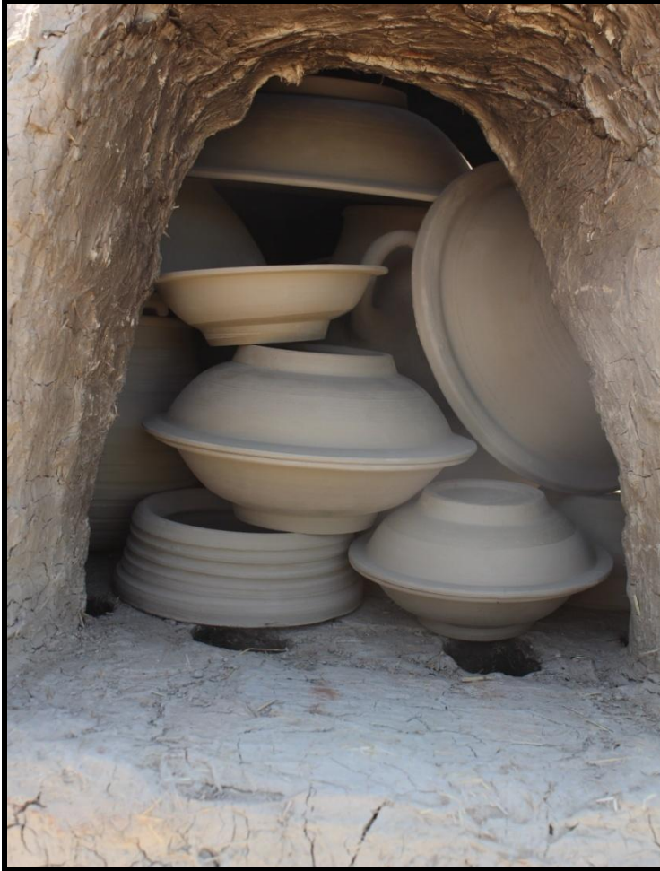
Resim 115. Fırına Yerleştirilmiş Ürünler.
