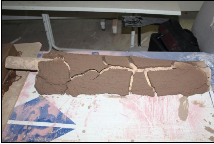
Resim 108. Kalıpta Çatlamalar (Kumluca Kili).
