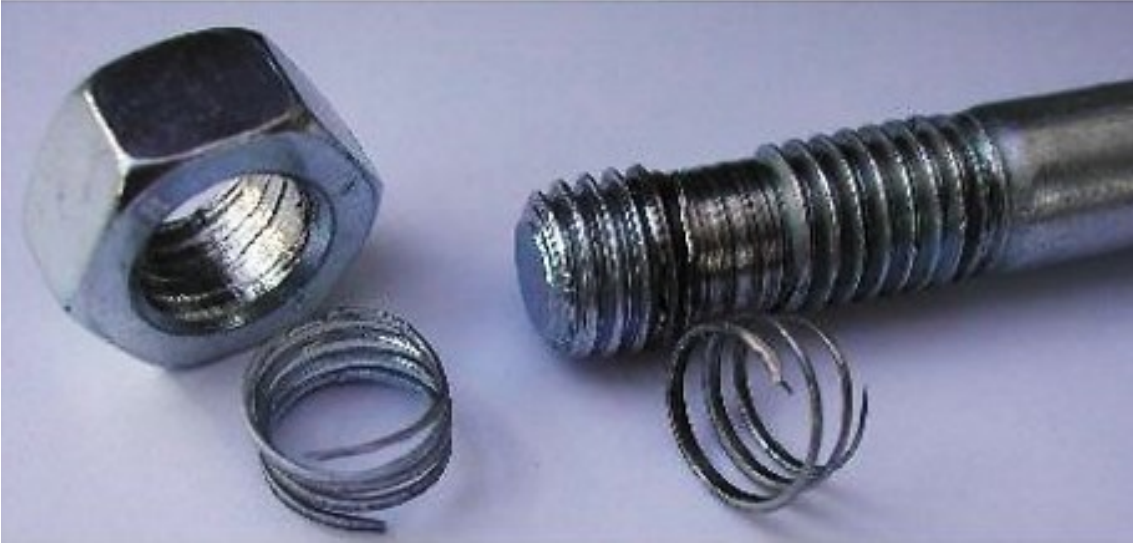
Şekil 2.22. Aşırı yüklendiği için deforme olan cıvata somun örneği
