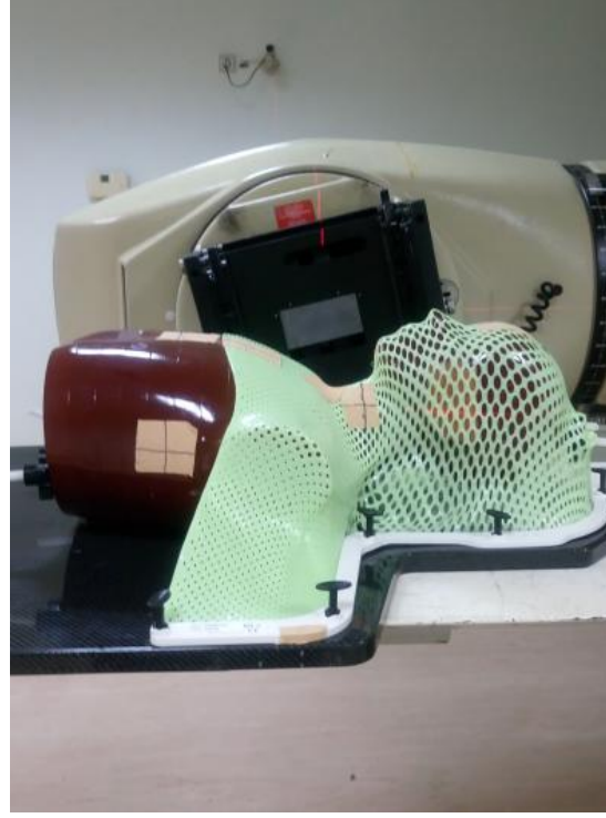
Şekil 3.25. Co-60 teleterapi cihazında rando fantom ışınması (A.Ü)
