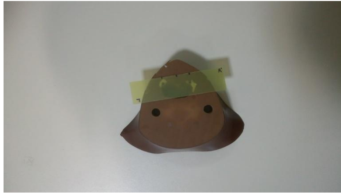
Şekil 3.14. Gafkromik film dozimetrelerin Rando fantoma yerleştirilmesi
