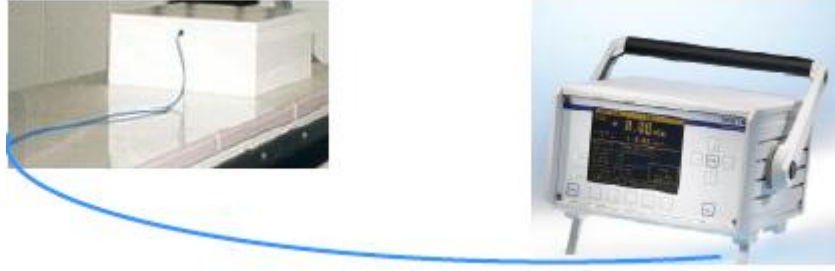
Şekil-2.19. Elektrometre ve doz ölçümü (A.Ü)
