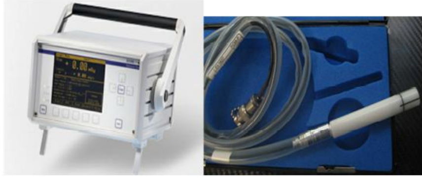
Şekil-3.4. DOSE 1 model elektrometre ve FC65P iyon odası (A.Ü)
