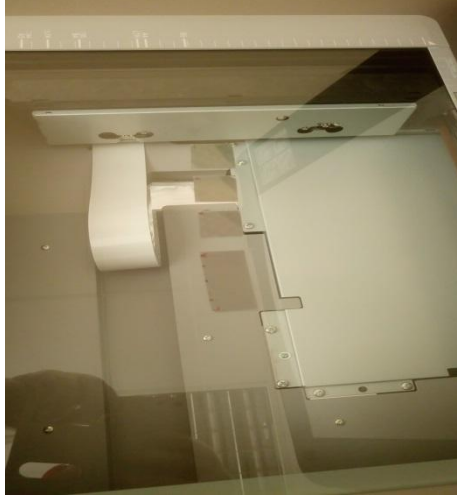
Şekil 3.26. Işınlanan EBT3 gafkromik filmlerin taranması
