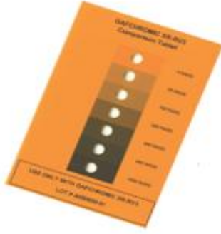
Şekil-2.26. Radyasyon sonrası gafkromik film üzerindeki renk değişimi (Lewis ve ark., 2012)
