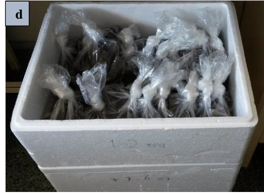
Şekil 3.2. a) Toprak örneği alım yöntemi, b) Toprak örneğinin sonda ile alımı, c) Sonda ile elde edilen toprak, d) Toprak örneklerinin strafor kolilerde muhafazası
