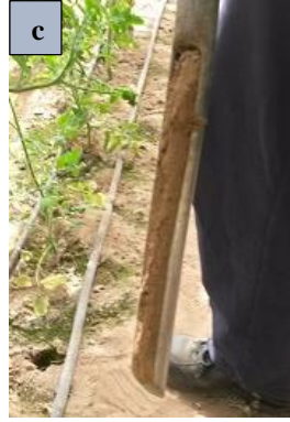
Şekil 3.2. a) Toprak örneği alım yöntemi, b) Toprak örneğinin sonda ile alımı, c) Sonda ile elde edilen toprak, d) Toprak örneklerinin strafor kolilerde muhafazası
