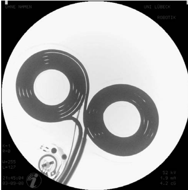
Şekil 2.6. Sekiz şekilli bobinin X-ray görüntüsü
