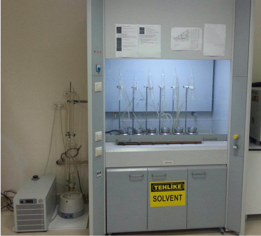
Şekil 3.13. Sokslet özütleme düzeneği, çeker ocak ve sirkülasyonlu su banyosu
