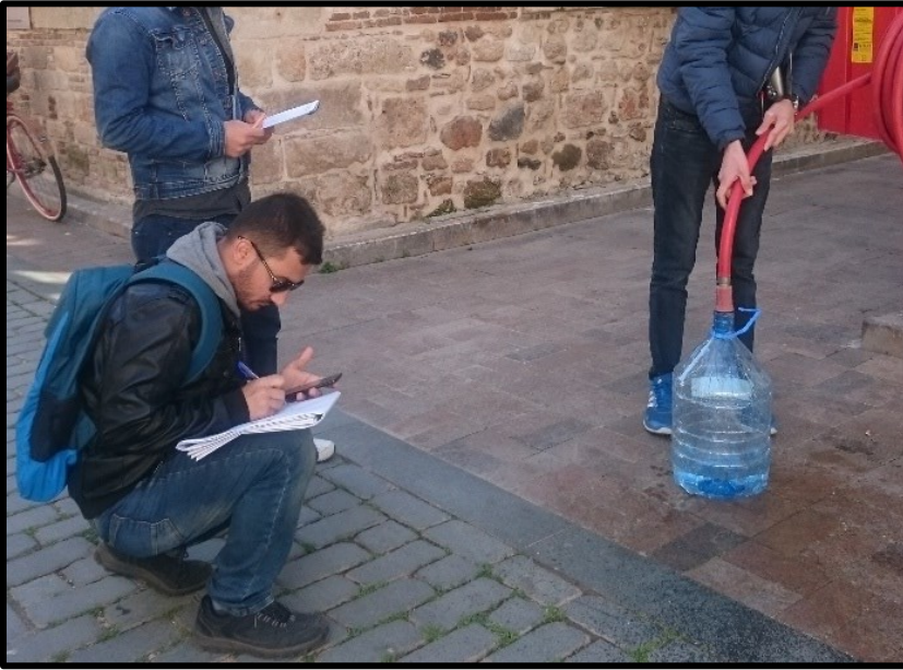
Şekil 4.3. Yangın musluklarının debisinin belirlenmesi
