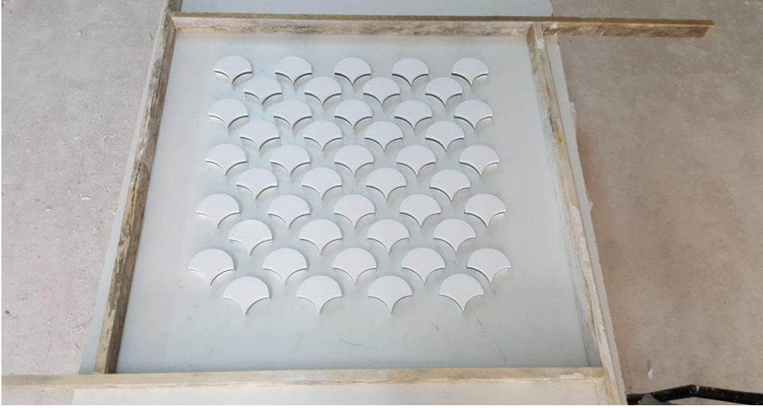
Resim-57: Modellerin etrafının kasnaklar yardımı ile çevrilmesi
