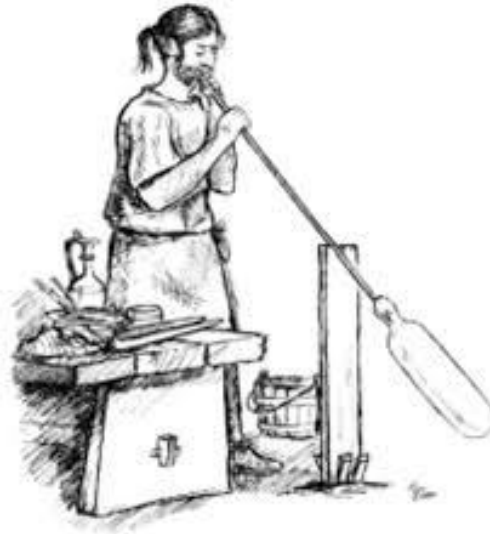
Resim-9: Cam üfleme yöntemi
