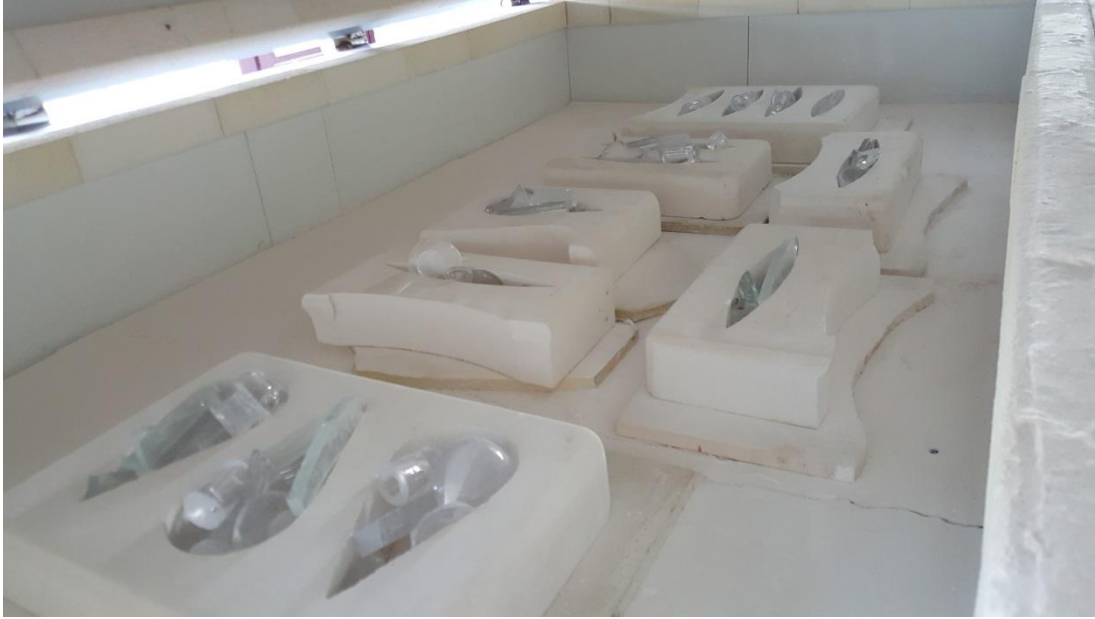
Resim.53-54: Pişirime hazır kalıplar ve pişirim sonucu elde edilen camlardan örnekler
