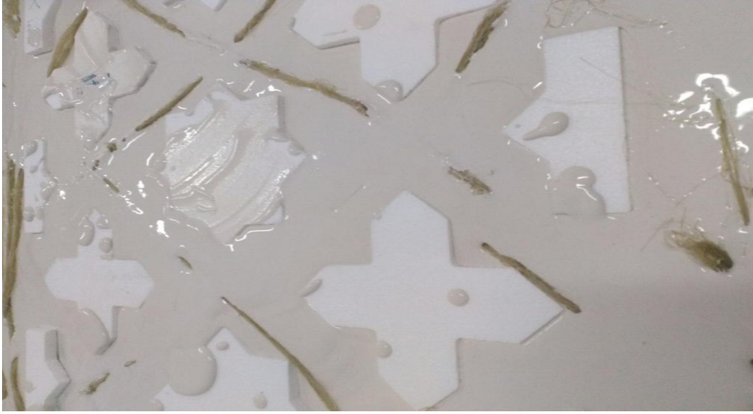
Resim-58: Alçı dökümü ve keten liflerin yerleştirilmesi
