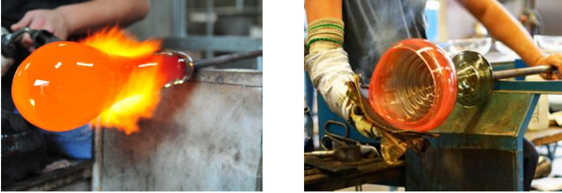
Resim10-11: Üfleme Tekniđi yapım aşamaları
