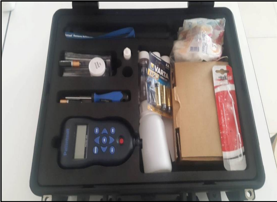
Şekil 3.8.Arazide kullanılan Palintest ( MACRO 900 ) cihazı
