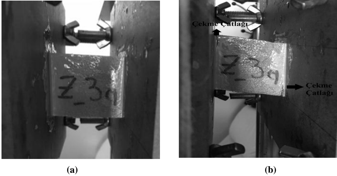
Şekil 4.3. Zayıf düzlemde test edilen üçüncü numunenin a) deney öncesindeki görüntüsü; b) deney sonundaki deforme olmuş görüntüsü
