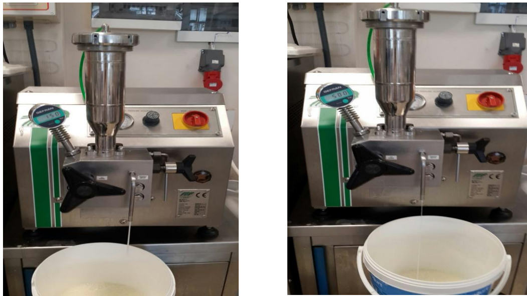
Şekil 3.1. Dondurma üretimlerinde dondurma karışımlarına uygulanan homojenizasyon işlemi
