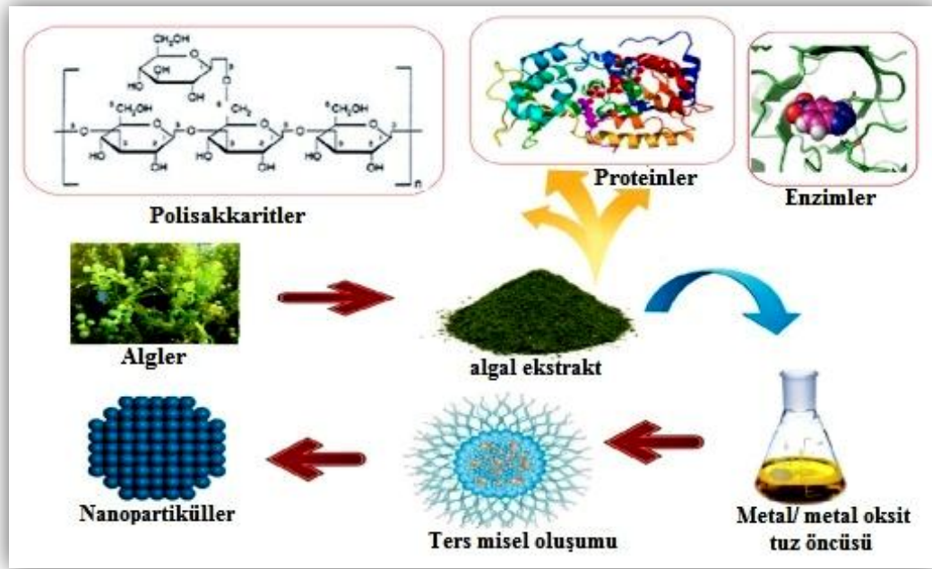
Şekil 2.10. Algler kullanılarak nanopartiküllerin biyosentez akışı (Sharma vd. 2015)
