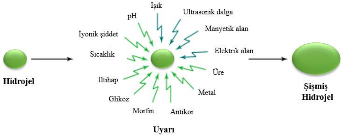
Şekil 1.3. Uyarılara duyarlı bir hidrojelin şişerek cevap vermesi (Gupta vd. 2002)
