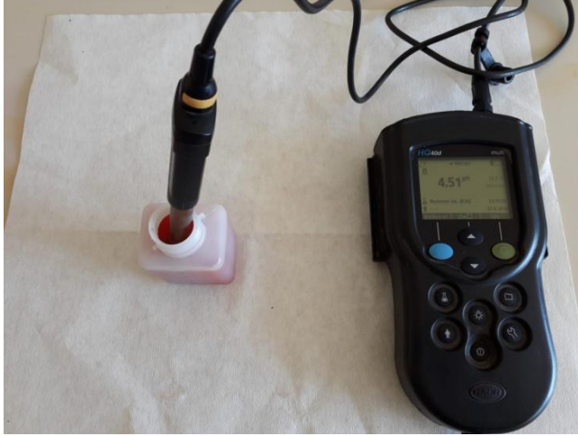
Şekil 3.7. Meyve suyunda EC-pH ölçümü
