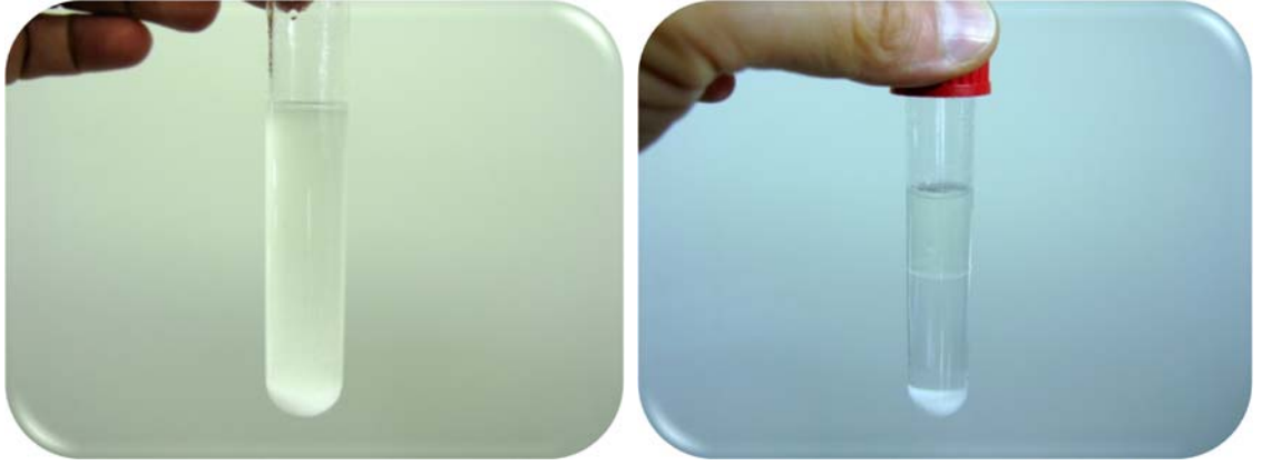
Şekil 3.11. Vortekslenen tüplerde yağ asidi metil esterlerini içeren hekzan fazının (üst faz) ayrılması
