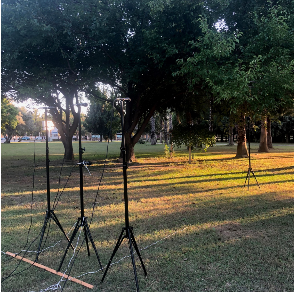
řekil 4.6. 70 cm aralıklar ile yerleřtirilmiř mikrofon dizini.
