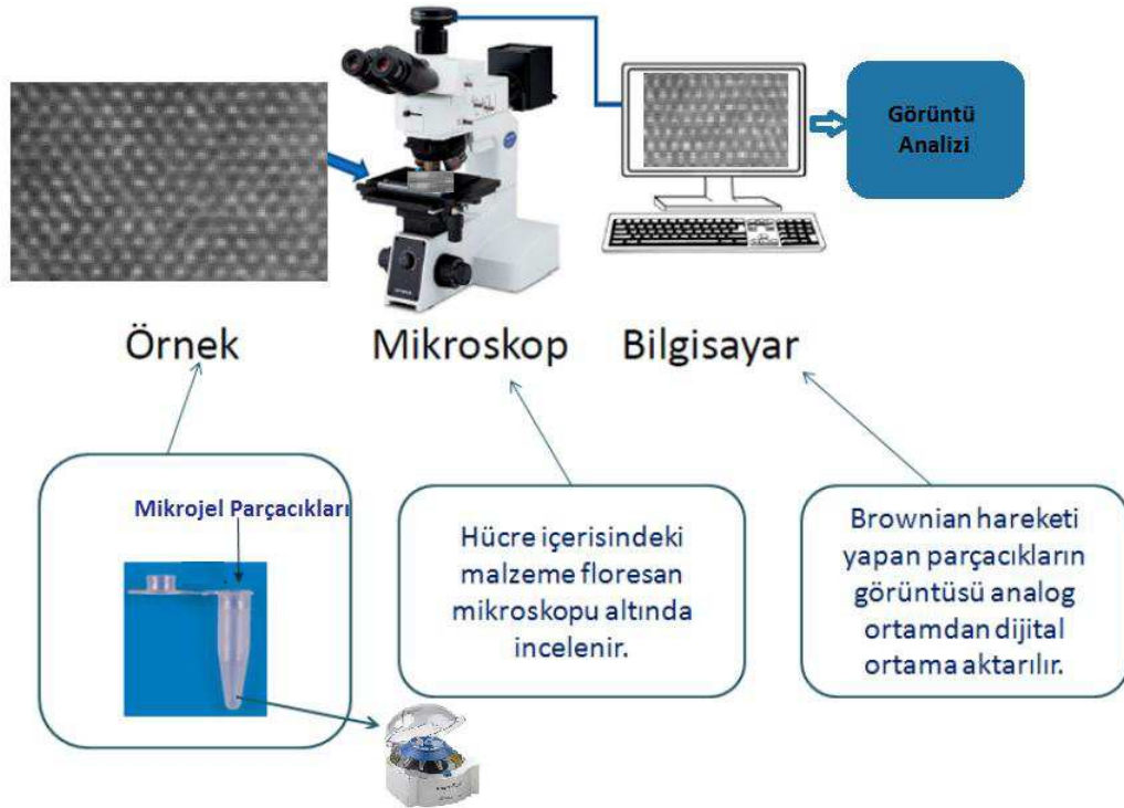
Şekil 3.6. Mikrojel parçacıklarını görüntülemeye hazır hale getirme süreci (Gençaslan 2017).
