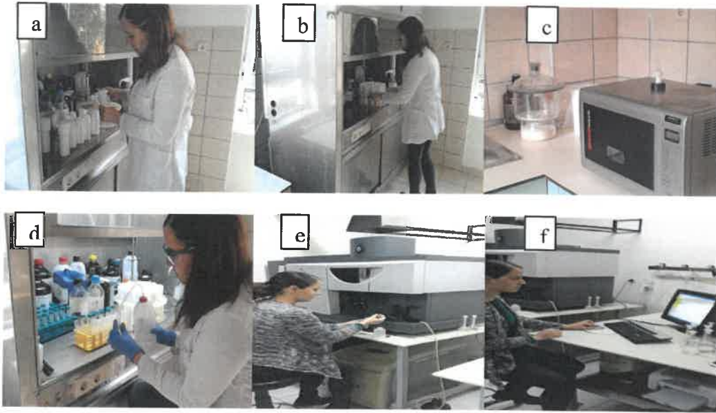
Şekil 3.3. Ağır metal analiz aşamaları; a) Örneklere kimyasal ilavesi; b) Yakma tüplerinin mikrodalga fırına götürülmesi; c) Kullanılan mikrodalga fırın; d) Örneklerin 15 ml'ye tamamlanması; e) Metal analizleri; f) Veri analizleri
