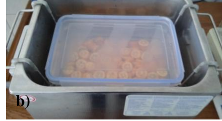
Şekil 3.12. a) Ultrasonik su banyosu; b) Kamkat dilimlerinin ultrason destekli ozmotik kurutulması işlemi
