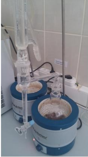
Şekil 3.18. Toplam kuru madde tayini için kullanılan düzenek
