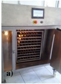
Şekil 3.6. a) Laboratuvar tipi tepsili kurutucu; b) Taze kamkat dilimlerinin kurutma öncesi tepsideki görünümü
