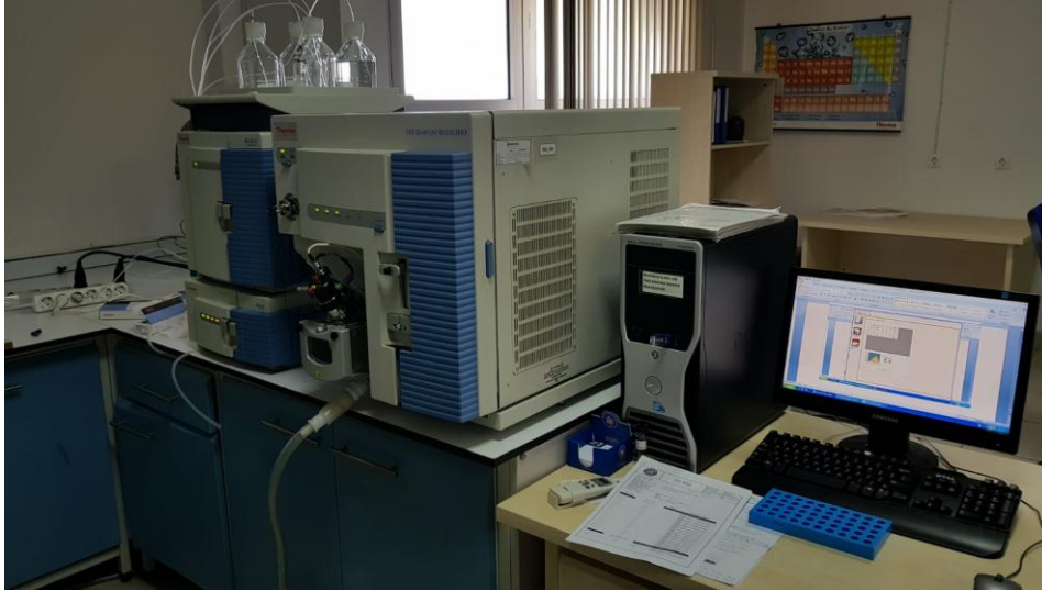
Şekil 3.1. Pestisit analizinde kullanılan sıvı kromatografi tandem kütle spektrometre cihazı görüntüsü
