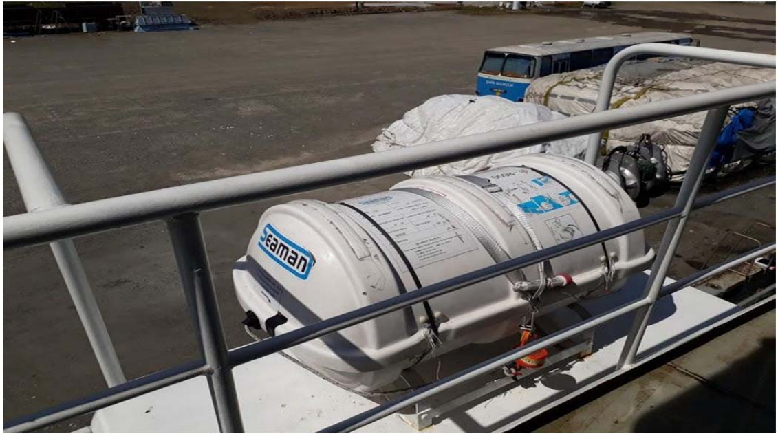
Şekil 4.4.2. Can kurtarma araçları balıkçı gemisinde yerleşimi
