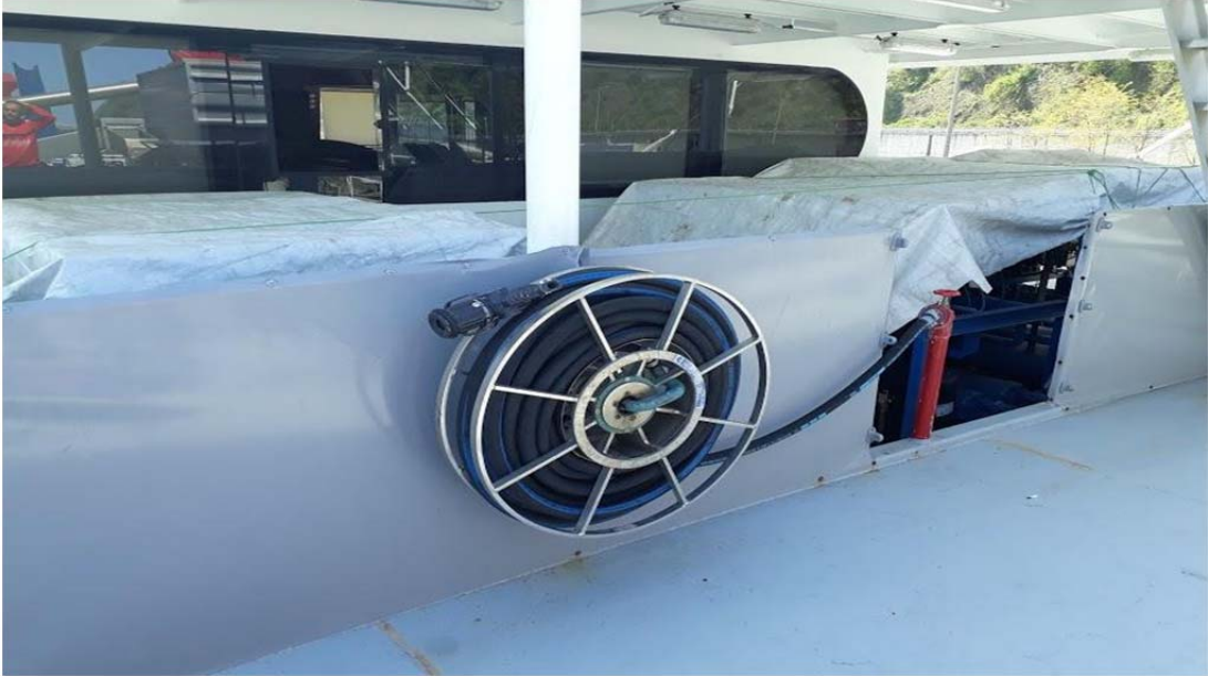
Şekil 4.10.2. Yangın hidrat sistemi
