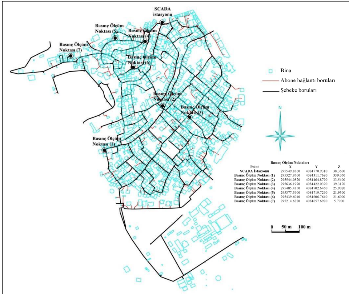
Şekil 3.1. Çalışma sahasında basınç ölçüm noktalarının konumları (Not: Z: Basınç ölçüm noktasının kotu, koordinatlar UTM cinsindedir) (Muhammetoğlu 2017'den alınmıştır)
