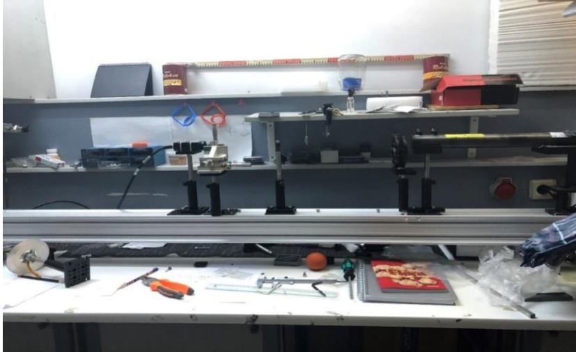
Şekil 3.1. He-Ne lazer ve Bessel ile Bessel-Vortex hüzmeleri şekillendirme deney düzeneği
