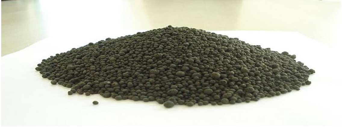
Şekil 3.2. Tarla denemesinde kullanılan stabilize edilmiş ve kurutulmuş arıtma çamuru
