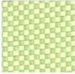
Şekil 2.5. Hasır biçiminde örülmüş cam elyaf tabakası (Ekici 2009).
