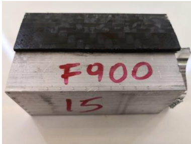
Şekil 4.14. Yedi numaralı karbon elyaf numune
