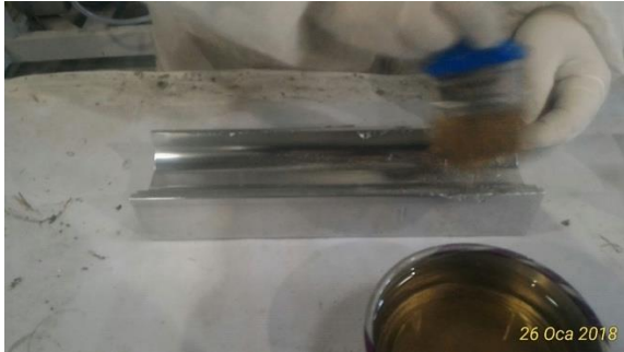
Şekil 3.5. İlk kat epoksi uygulama işlemi
