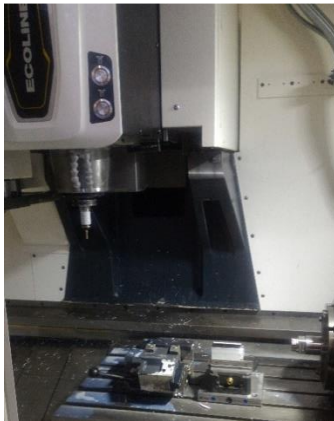
Şekil 3.11. CNC dik İşleme merkezi ve bağlama sistemi
