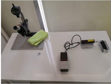
Şekil 3.13. Numune-dedektör yerleşimi ve yüzey pürüzlülüğü ölçümü.
