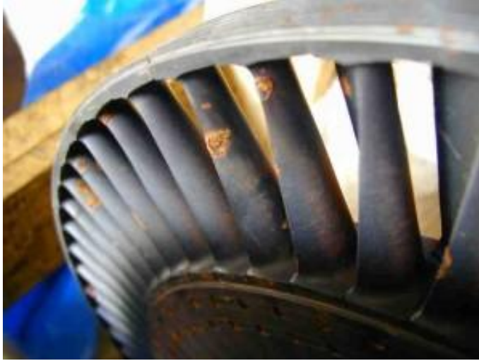
Şekil 2.9. Korozyona uğramış bir buhar türbini (Dave 2015)
