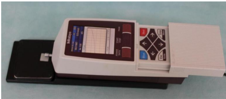
Şekil 3.1.3.1. Çalışmada kullanılan profilometre cihazı ile yüzey pürüzlülüklerinin ölçülmesi
