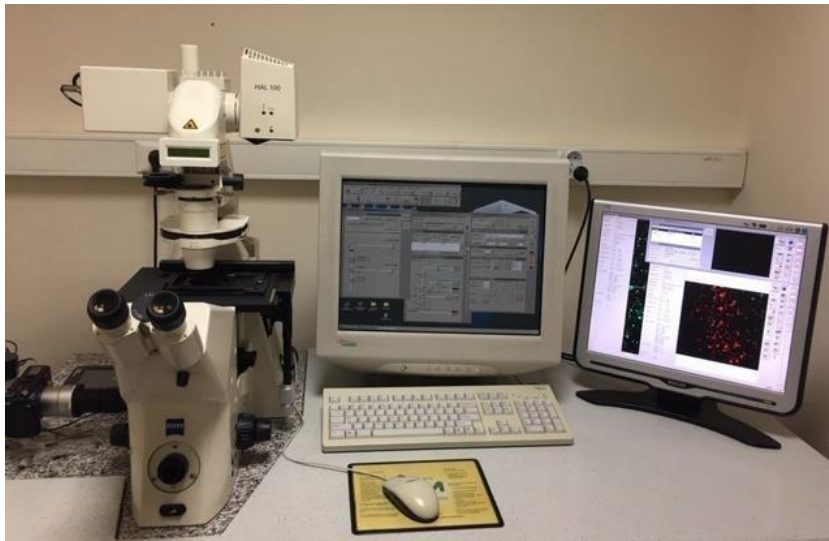
Şekil 3.7.3. Görüntüleme için kullanılan konfokal lazer taramalı mikroskopu
