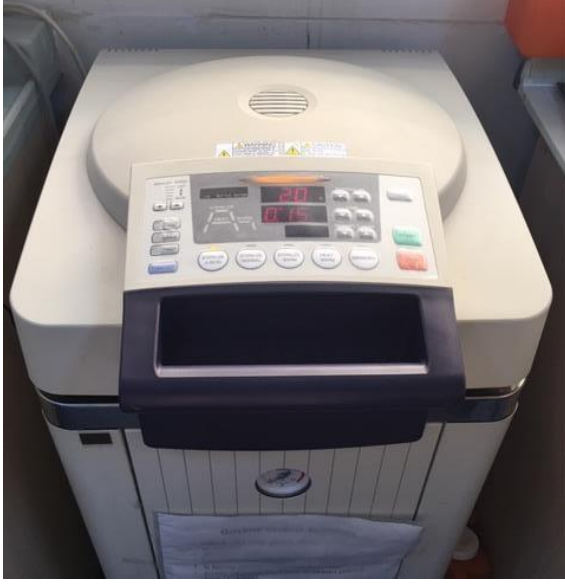
Şekil 3.6.1. Örneklerin sterilize edilmesinde kullanılan otoklav
