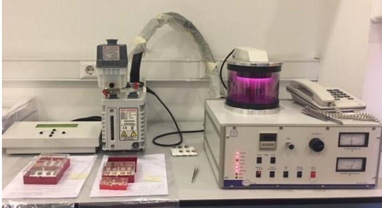
Şekil 3.5.1. Örneklerin yüzeyini kaplamak için kullanılan Polaron Range püskürtme kaplayıcı (sputter coater)
