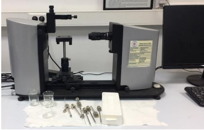
Şekil 3.4.1. Çalışmada kullanılan Yüzey Gerilimi – Temas Açısı Ölçüm Cihazı (Optik Gonyometre)
