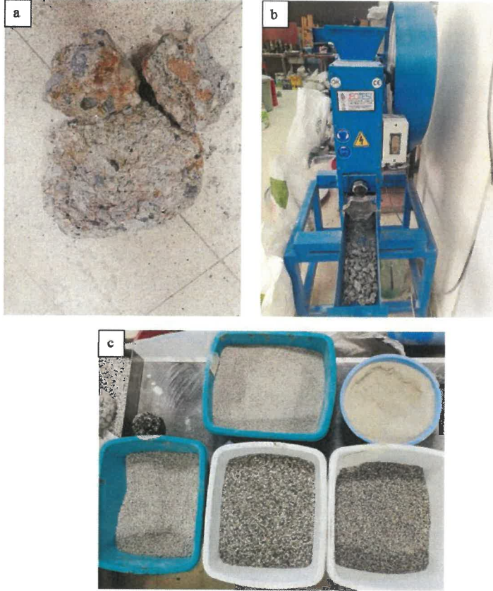
Şekil 3.1. a) Beton molozları; b) Beton molozların konkasörden kırılması; c) Beton atık agregaların kırma eleme sonrası
