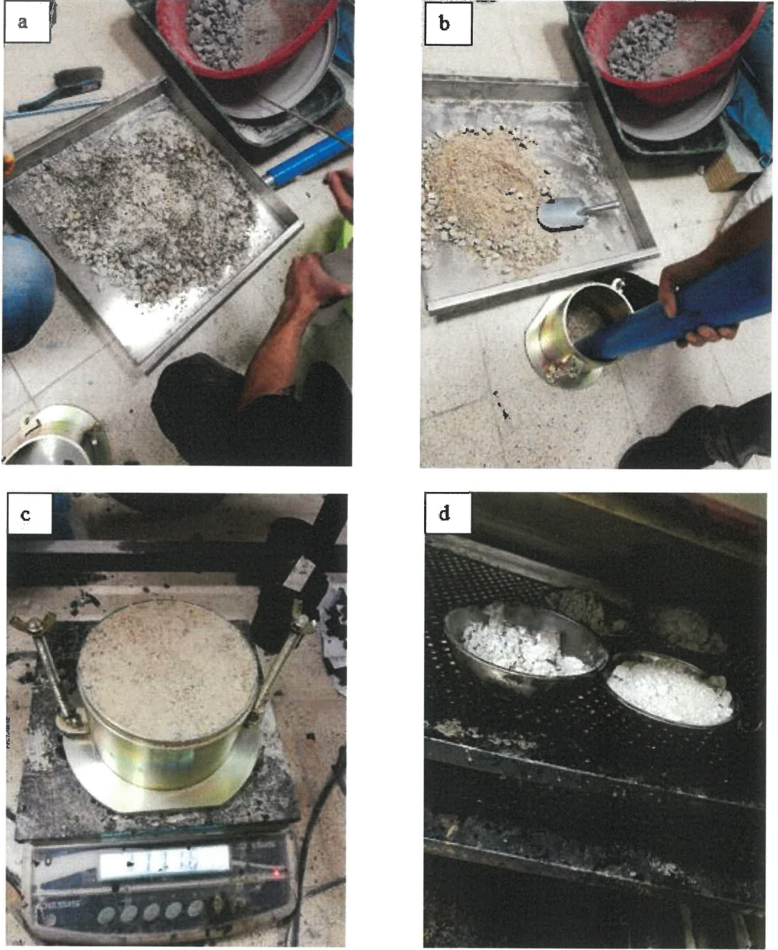
Şekil 3.9. a) Malzemelerin homojen bir şekilde karıştırılması; b) Tokmak ile sıkıştırma işlemi; c) Kalıp ile yaş numunenin ağırlığının kaydedilmesi; d) Su içeriğinin belirlenmesi için yaş numune örneklerinin etüvde kurutulması
