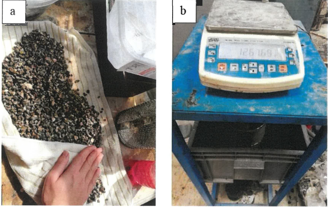
Şekil 3.2. a) Yüzeyin doymun kuru hale getirilmesi; b) Tel sepet ile numunelerin su tankında tartılması
