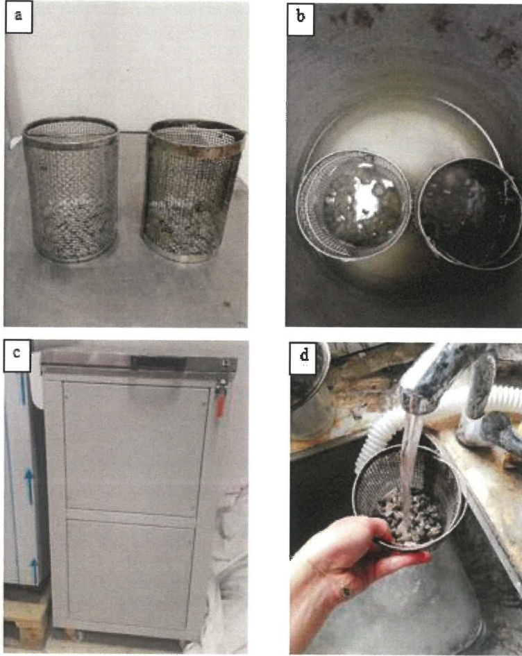
Şekil 3.7. a) Numunelerin tel sepetlere konulması; b) Tel sepetlerin magnezyum sülfat çözeltisine konulması; c) Magnezyum sülfat çözeltili kabın su banyosunda bekletilmesi; d) Deney sonucunda numunelerin magnezyum sülfat çözeltisinden arındırılması için yıkanması
