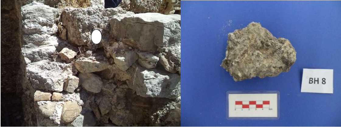
Şekil 3. 31. BH8 kodlu harç numunesi
