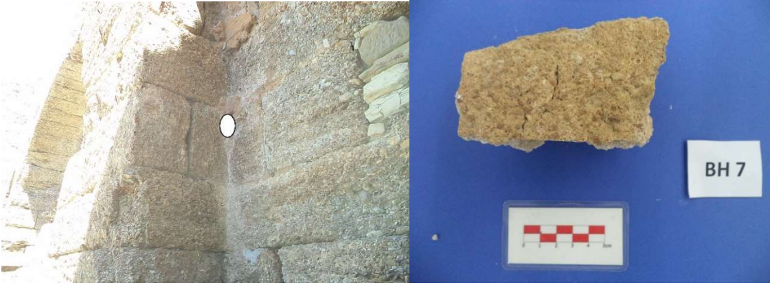
Şekil 3. 30. BH7 kodlu harç numunesi
