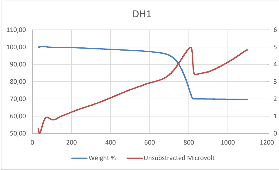
Şekil Ek-4. 7. DH1 numunesi TGA/DTA sonuçları
