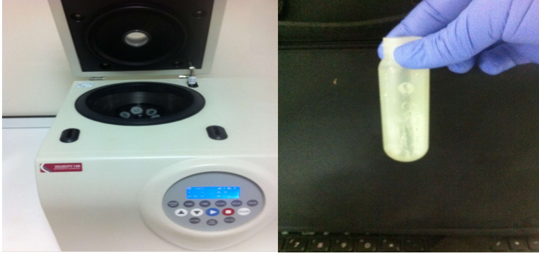
Şekil 3. 45. Sülfat ve karbonat analizi
