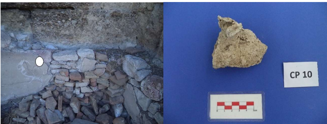
Őekil 3. 16. CP10 kodlu sıva numunesi
