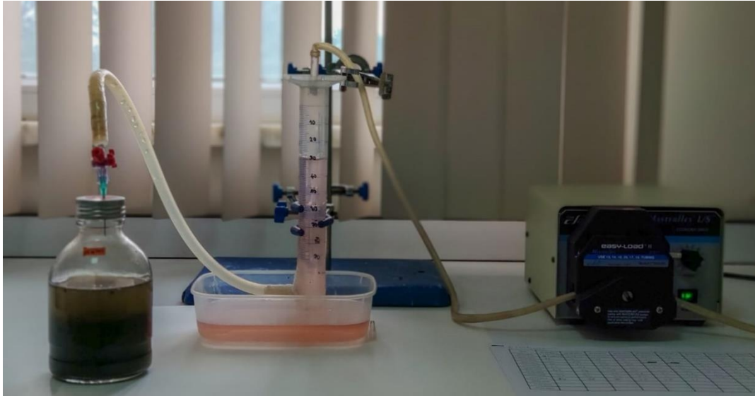
Şekil 3.16. Biyogaz hacmi ölçüm düzeneği
