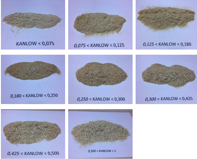
Şekil 4.1. Elek analizi sonunda farklı gözenek çaplı elekler üzerinde kalan materyal
