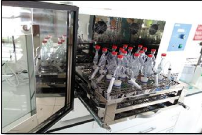
Şekil 3.12. SSF için hazırlanan ve çalkalamalı inkübatöre yerleştirilen reaktörler
