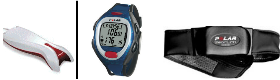
Şekil 3.4. Polar 610i, Göğşe Takılan Algılayıcı ve Veri Aktarım Cihazı (interface)
