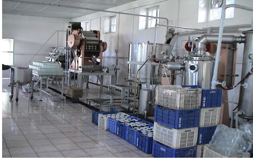
Şekil 3.2. Brown tipi ekstraksiyon sistemi
