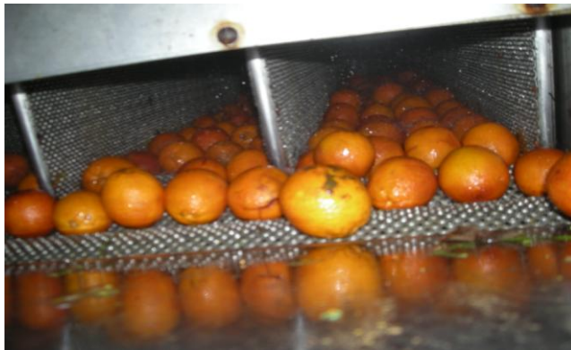
Şekil 3.3. Kan portakalının kabuk yüzeyinin çizilerek kabuk yağının ayrılması
