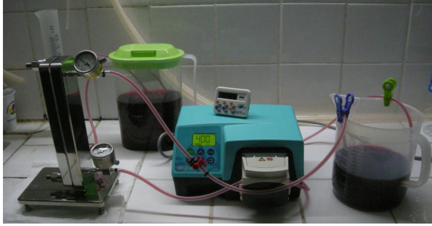
Şekil 3.6. Laboratuvar tipi ultrafiltrasyon sistemi
